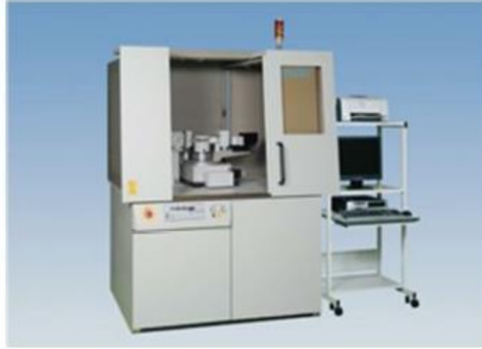
Şekil 7.8. Rigaku D/MAX 2000 marka X-ışınları difraktometresi
