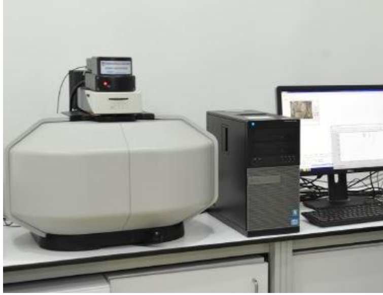
Şekil 7.9. Kaiser RAMANRXN1 marka raman spektroskopi cihazı
