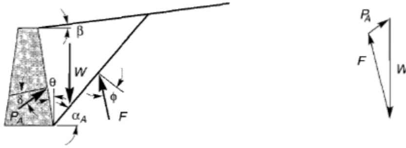
Şekil 4.8. Aktif durum için Coulomb kaması ve kuvvet bileşeni (Kramer,1996) [4].
