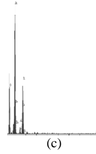
Şekil 6.11. (a) 950 ° C'de 4 saat ısıtma işlemi uygulanmış ZAS-A kodlu cam-seramiğin mikroyapısı, (b) 1 (c) 2 ve (d) 3 numaralı bölgelerin EDS analizleri
