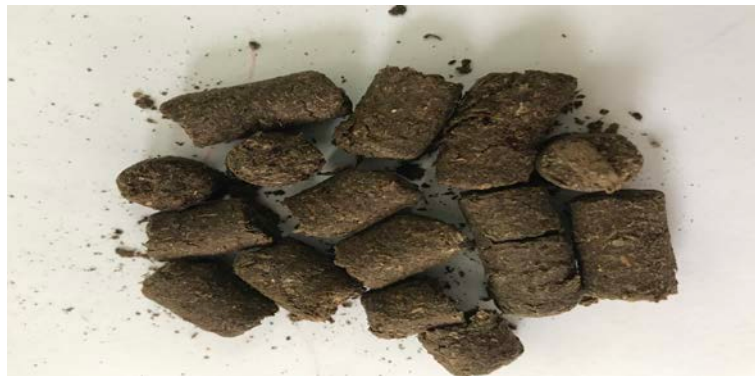
Şekil 3.5. Çalışmada incelenen broyler tavuk altlığının peletlenmiş hali.
