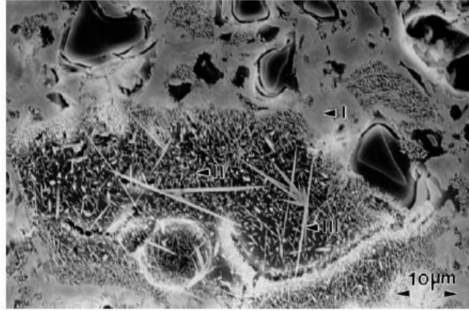
Şekil 3.11. Müllitin üç tipini de içeren porselenin SEM görüntüsü [101].
