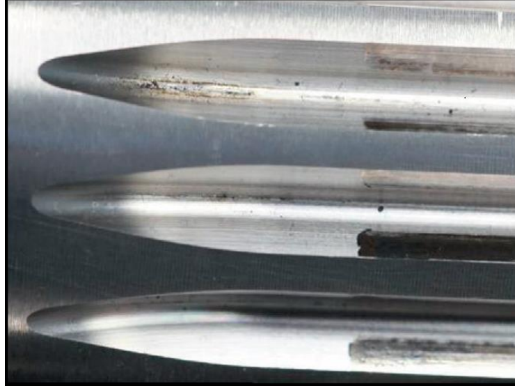
Şekil 3.9. Dişlerde oluşan aşınma örneği [21]
