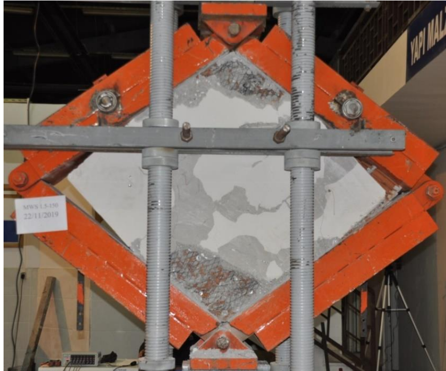
Şekil 5.8. MBW 1,5-150 deney elemanın deneyden sonra hasar durumu
