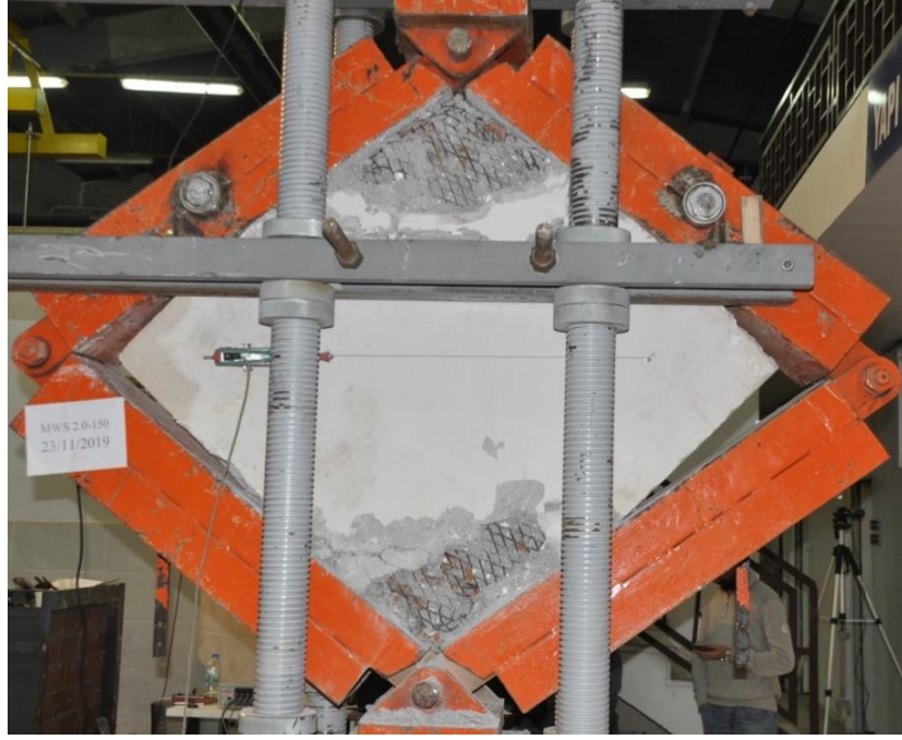
Şekil 5.11. MBW 2,0-150 deney elemanının deneyden sonra hasar durumu
