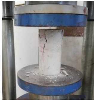
Şekil 4.10. Harç numunelerin kırılma durumu
