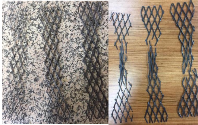
Şekil 4.5. Çelik levhaların deneyden önce ve sonraki durumu
