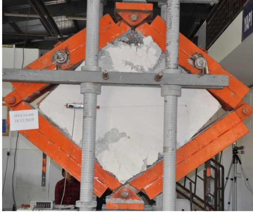
Şekil 5.5. MBW 3.0-400 deneme elemanının deneyden sonra hasar durumu
