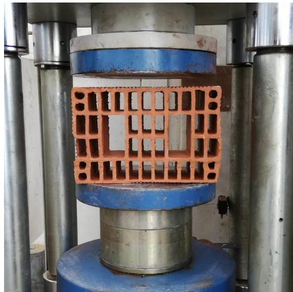
Şekil 4.2. Düşey delikli tuğlanın basınç makinesiyle kırılması
