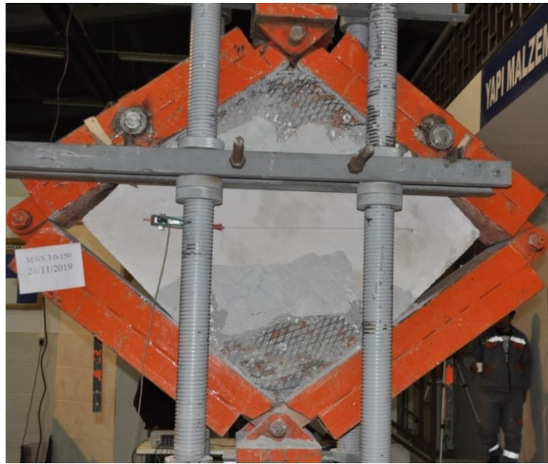
Şekil 5.14. MBW 3,0-150 deney elemanın deneyden sonra hasar durumu
