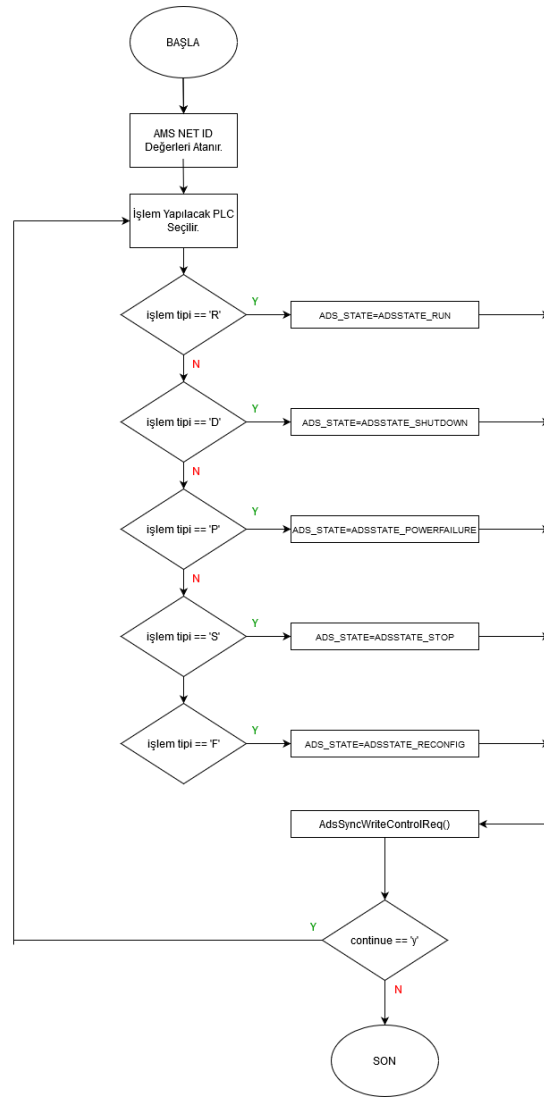
Şekil 3.4. PLC cihaz durum değişimi akış diyagramı
