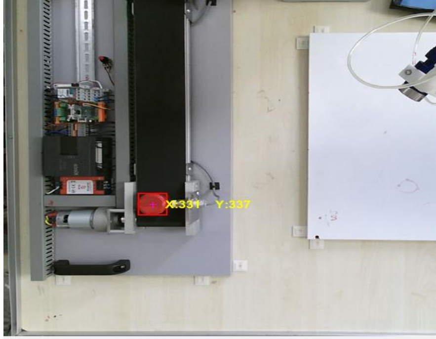
Şekil 3.10. Bounding box ve centroid
