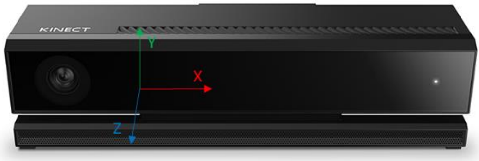
Şekil 2.3. Xbox One Kamera alanı koordinat sistemi [19]
