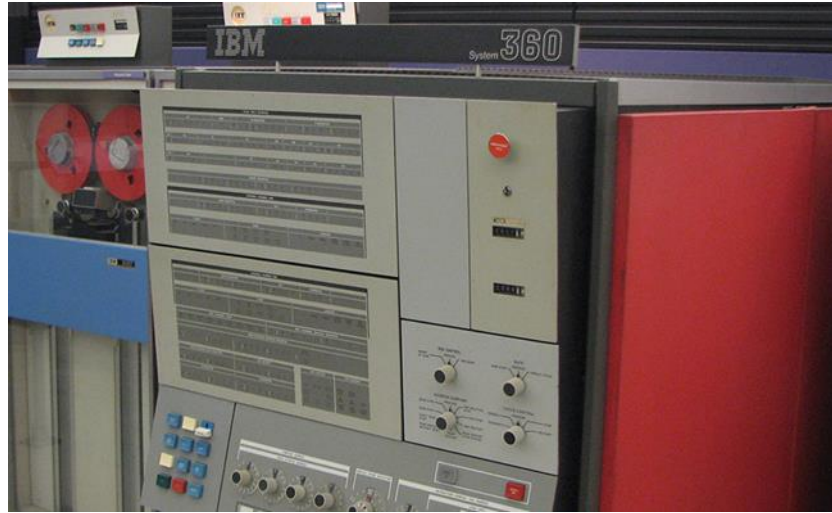
Şekil 2.7. IBM anaçatı bilgisayarlı birinci nesil SCADA [44].
