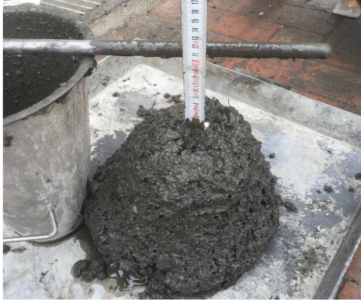
Şekil 3.9. Taze betonda çökme deneyi
