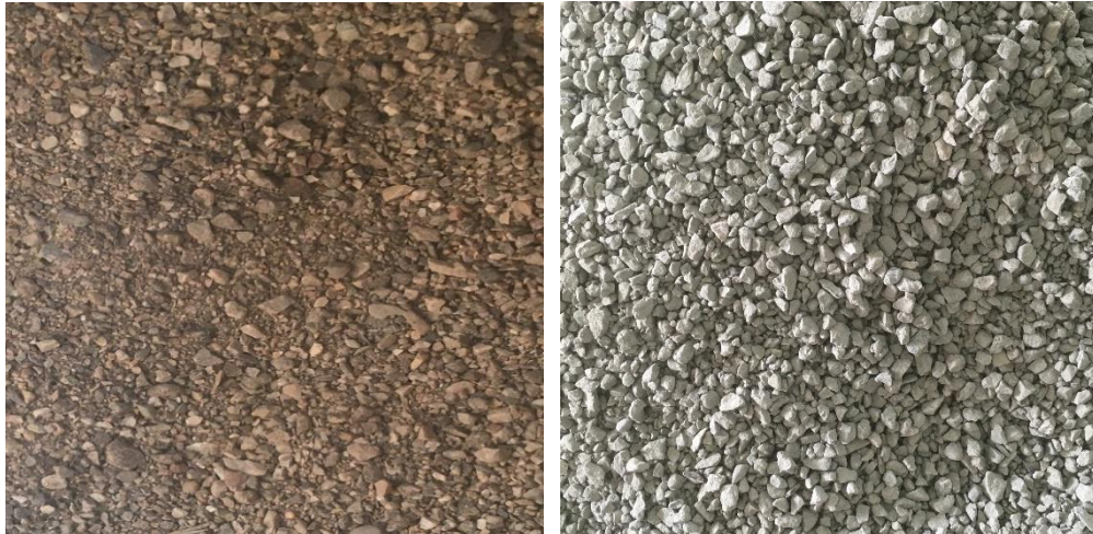
Şekil 3.1. Deneyde kullanılan kırma kum (solda) ve kırmataş (sağda)
