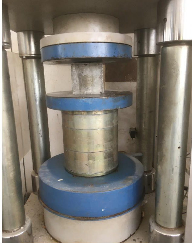
Şekil 3.11. Basınç dayanımı deneyi
