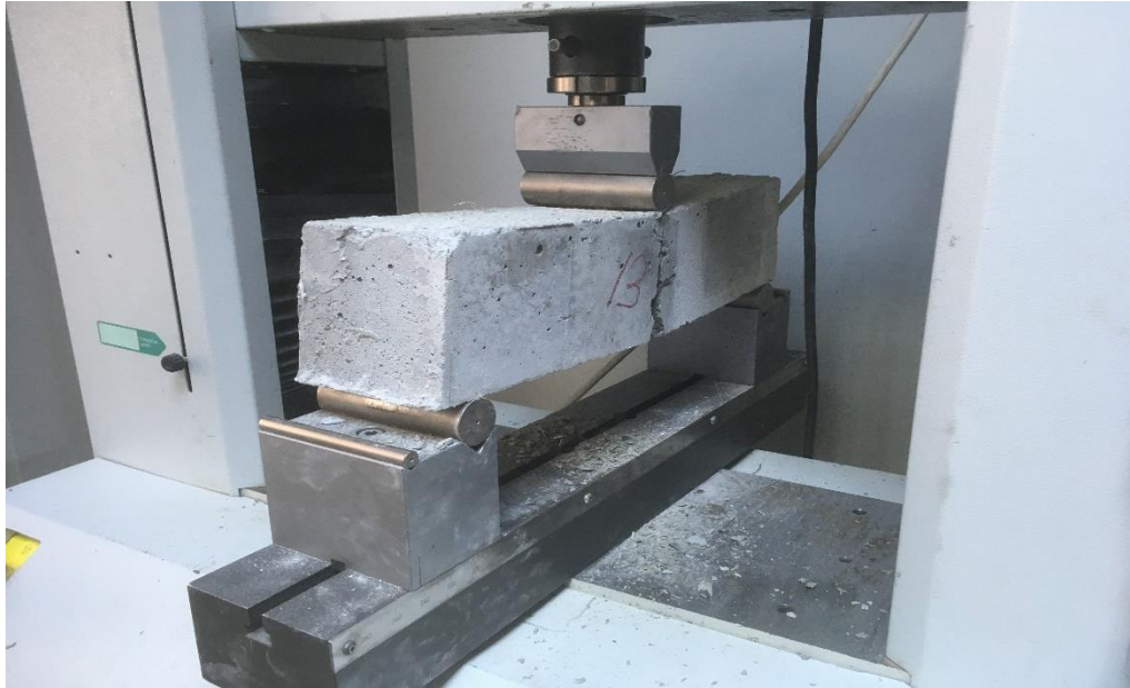
Şekil 3.14. Eğilme dayanımı deneyi
