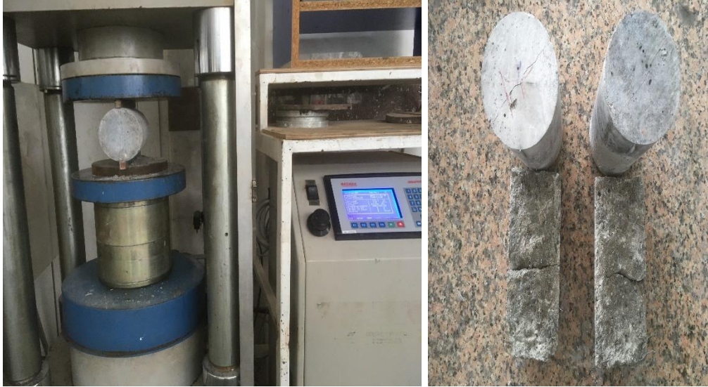
Şekil 3.12. Yarmada çekme dayanımı deneyi
