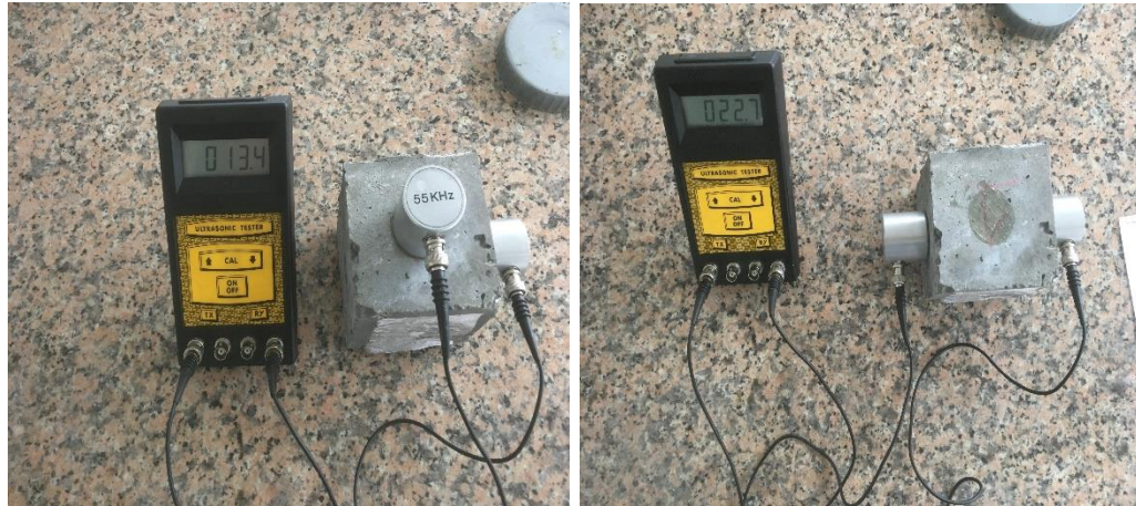
Şekil 3.10. Ultrases geçiş hızı deneyleri
