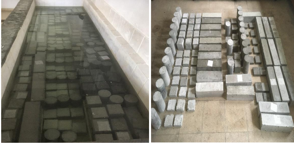
Şekil 3.8. Numunelerin kür havuzuna yerleştirilmesi ve oda sıcaklığında kurutulması
