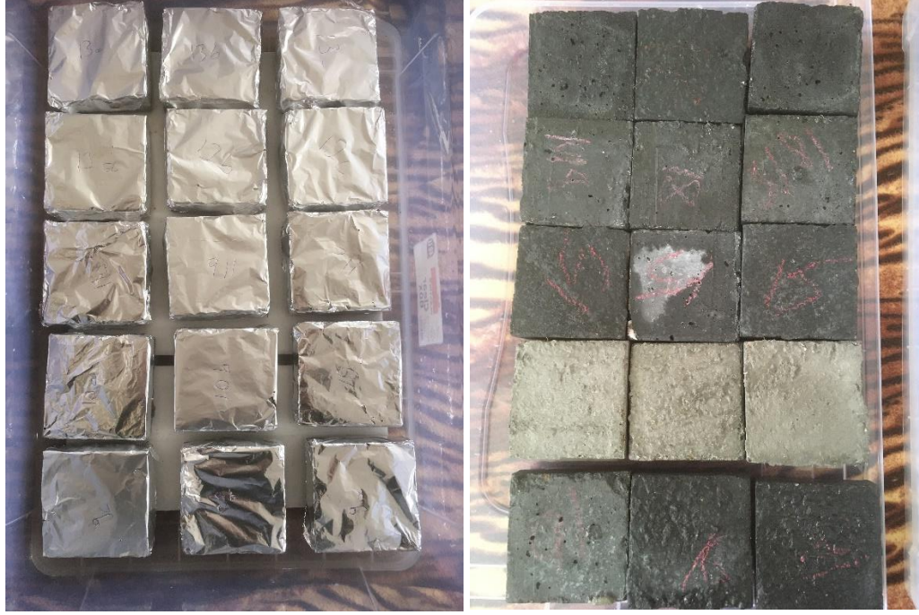
Şekil 3.13. Kapiler su emme deneyi
