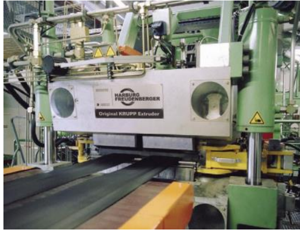
Şekil 4.2. Hamurun ekstrude edilip Tread'a dönüştürüldüğü kalıp çıkışı
