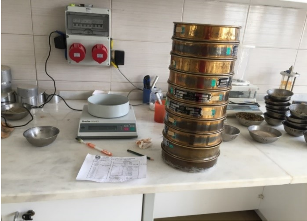
Şekil 4.14. Elek analizi deney düzeneği
