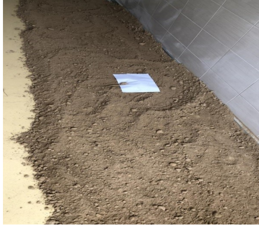
Şekil 4.2. Silt zeminin kurutulması
