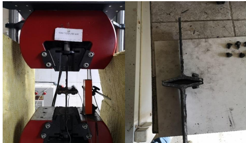
Şekil 3.50. I240-T600-200 \mu numunesinin çekme deneyi önce ve sonrası durumu.
