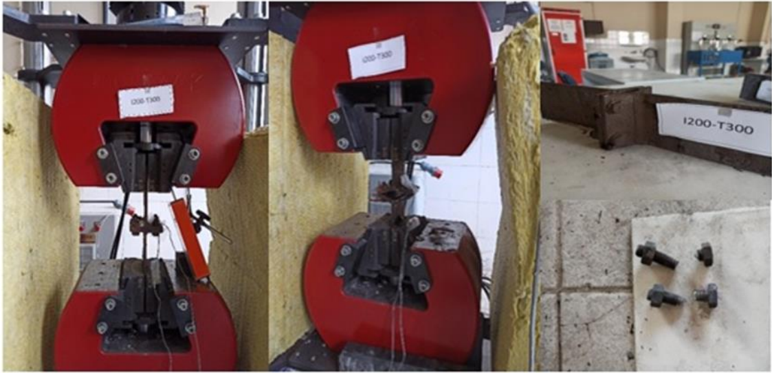
Şekil 3.3. IPE200-T300 numunesinin çekme deneyi önce ve sonrası durumu.
