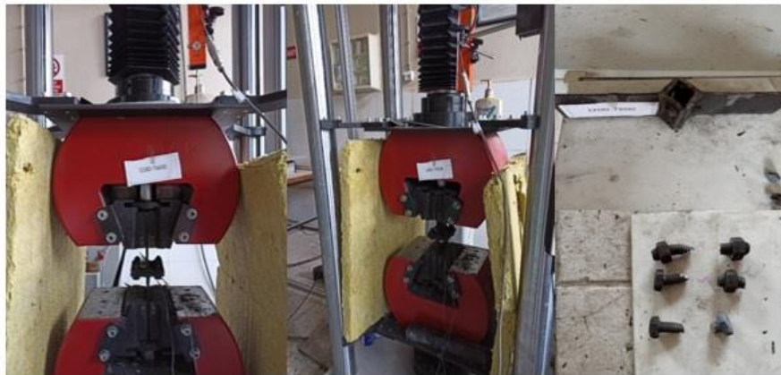
Şekil 3.25. IPE200-T600 numunesinin çekme deneyi önce ve sonrası durumu.
