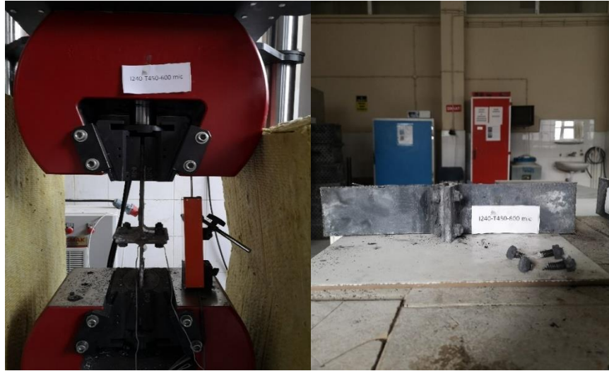
Şekil 3.59. I240-T450-600 \mu numunesinin çekme deneyi önce ve sonrası durumu.
