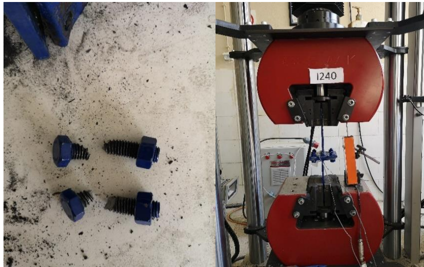
Şekil 3.65. I240 Numunesinin çekme deneyi sonrası durumu.
