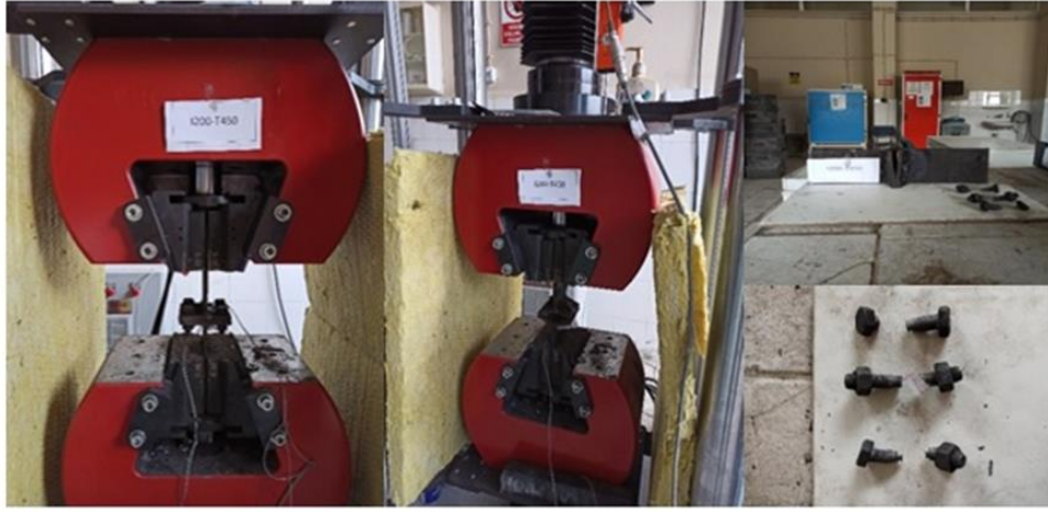
Şekil 3.4. IPE200-T450 numunesinin çekme deneyi önce ve sonrası durumu.
