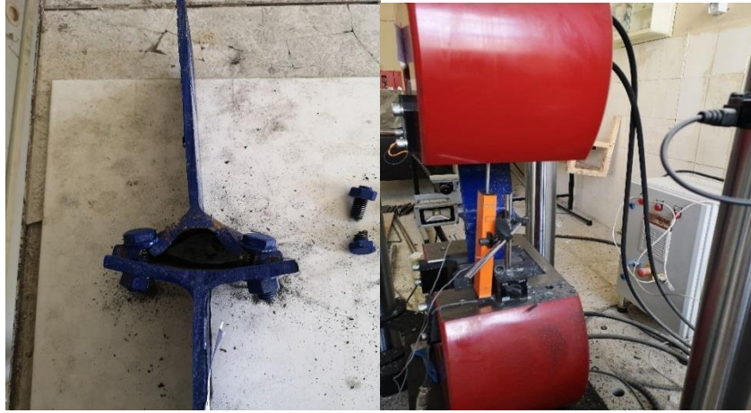
Şekil 3.64. I220 Numunesinin çekme deneyi sonrası durumu.
