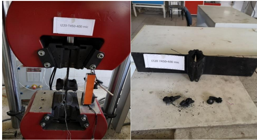
Şekil 3.34. I220-T450-400 \mu numunesinin çekme deneyi önce ve sonrası durumu.
