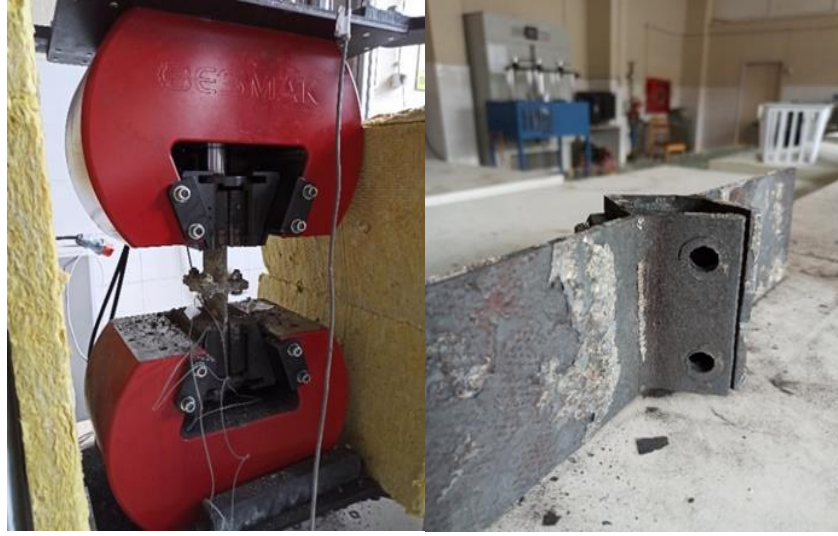
Şekil 3.21. IPE200-T1000-600 \mu numunesinin çekme deneyi önce ve sonrası durumu.
