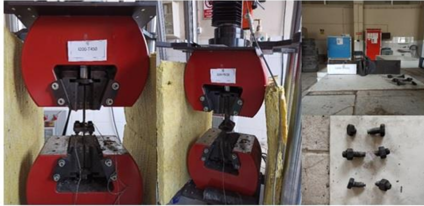
Şekil 3.24. IPE200-T450 numunesinin çekme deneyi önce ve sonrası durumu.
