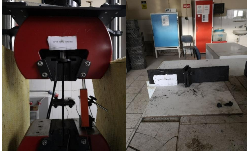
Şekil 3.58. I240-T300-600 \mu numunesinin çekme deneyi önce ve sonrası durumu.
