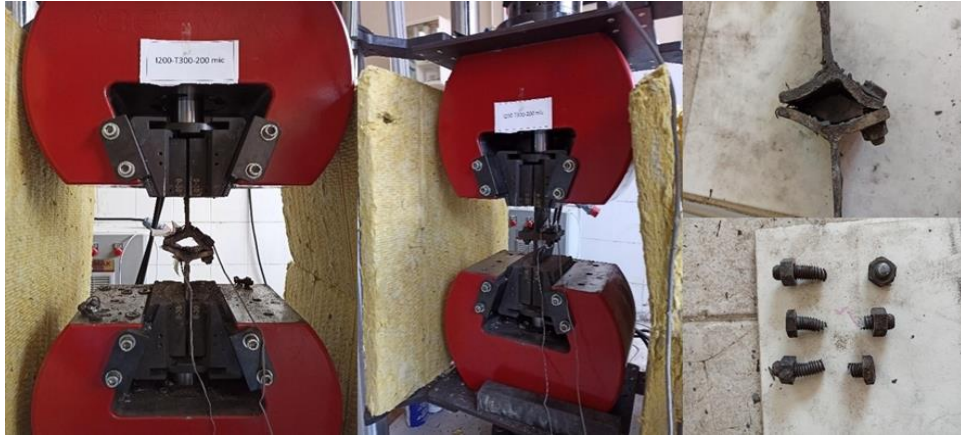
Şekil 3.8. IPE200-T300-200µ numunesinin çekme deneyi önce ve sonrası durumu.
