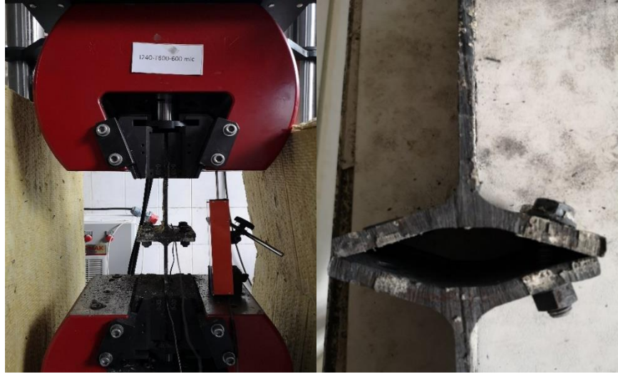
Şekil 3.60. I240-T600-600 \mu numunesinin çekme deneyi önce ve sonrası durumu.
