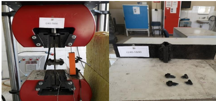
Şekil 3.45. I240-T600 Numunesinin çekme deneyi sonrası durumu.
