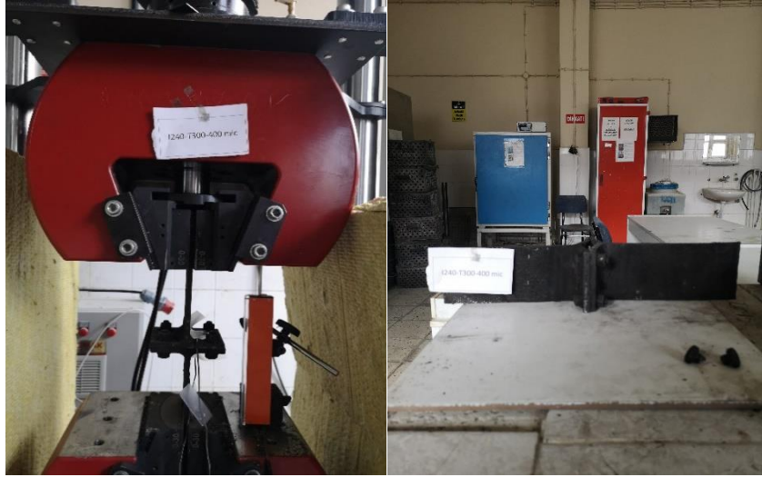
Şekil 3.53. I240-T300-400 \mu numunesinin çekme deneyi önce ve sonrası durumu.
