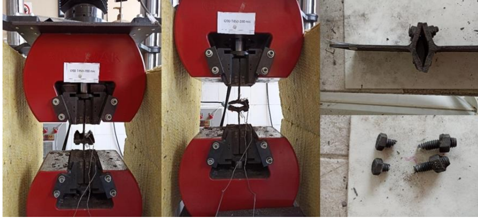
Şekil 3.9. IPE200-T450-200 \mu numunesinin çekme deneyi önce ve sonrası durumu.
