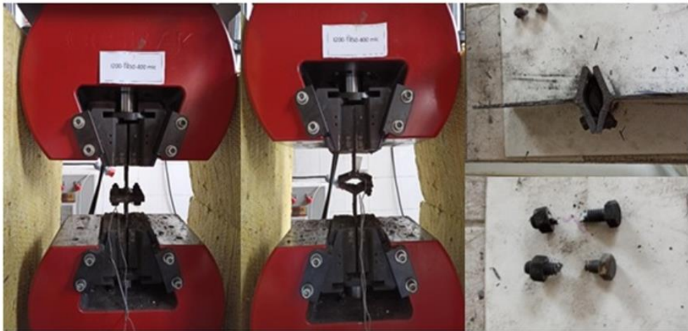
Şekil 3.14. IPE200-T450-400 \mu numunesinin çekme deneyi önce ve sonrası durumu.
