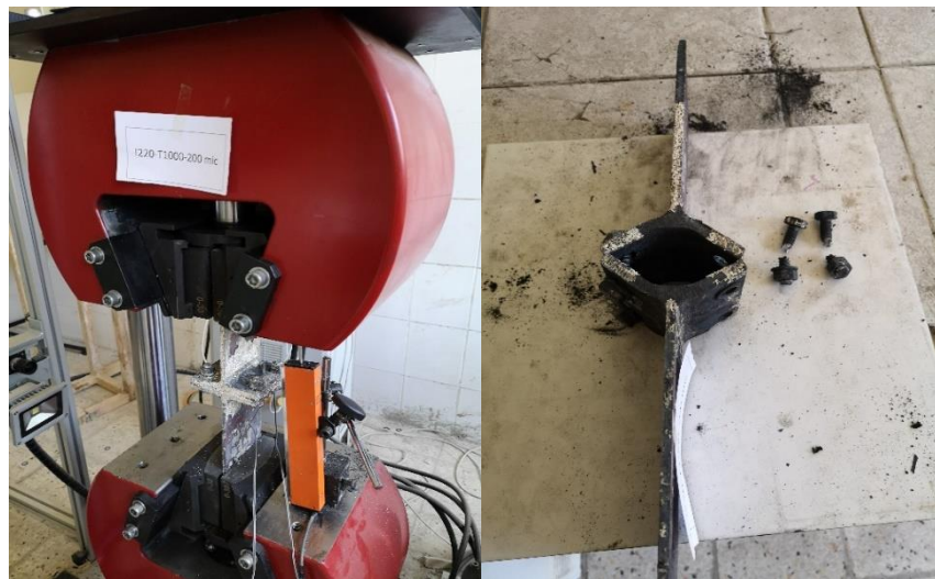
Şekil 3.31. I220-T1000-200 \mu numunesinin çekme deneyi önce ve sonrası durumu.
