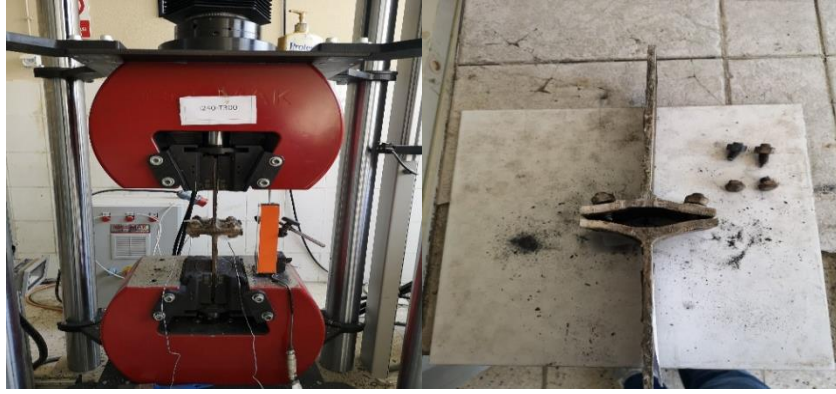
Şekil 3.43. I240-T300 Numunesinin çekme deneyi sonrası durumu.
