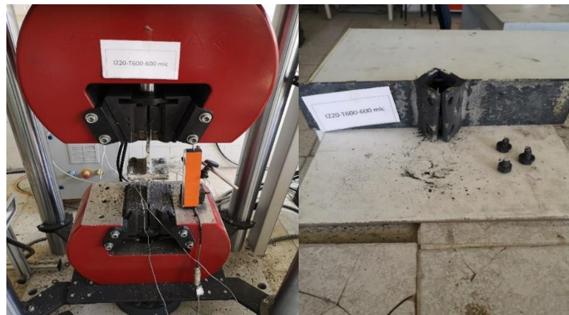
Şekil 3.40. I220-T600-600 \mu numunesinin çekme deneyi önce ve sonrası durumu.
