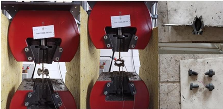
Şekil 3.11. IPE200-T1000-200 \mu numunesinin çekme deneyi önce ve sonrası durumu.
