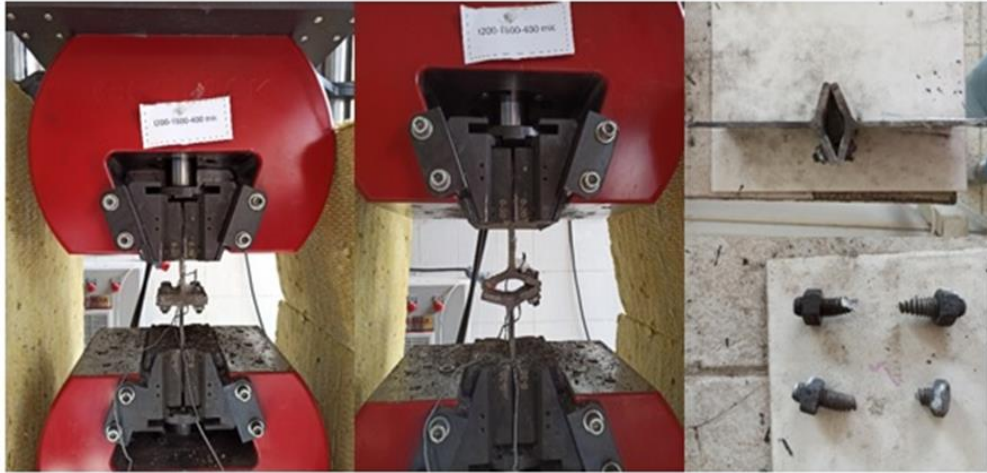
Şekil 3.15. IPE200-T600-400 \mu numunesinin çekme deneyi önce ve sonrası durumu.
