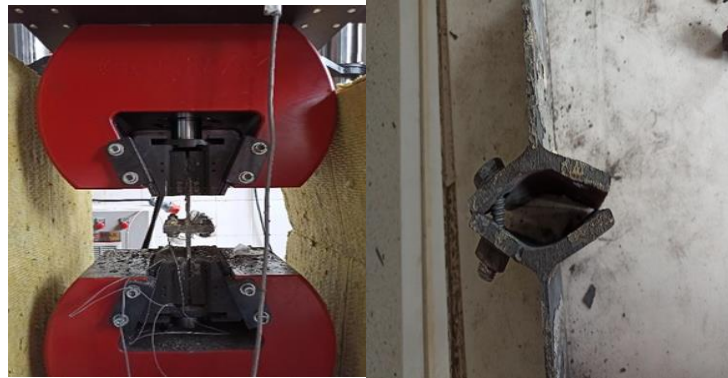
Şekil 3.20. IPE200-T600-600 \mu numunesinin çekme deneyi önce ve sonrası durumu.
