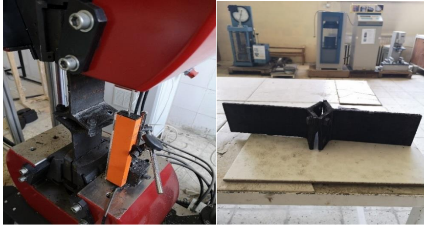
Şekil 3.29. I220-T450-200 \mu numunesinin çekme deneyi önce ve sonrası durumu.
