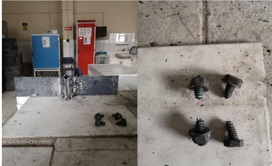
Şekil 3.61. I240-T1000-600 \mu numunesinin çekme deneyi önce ve sonrası durumu.
