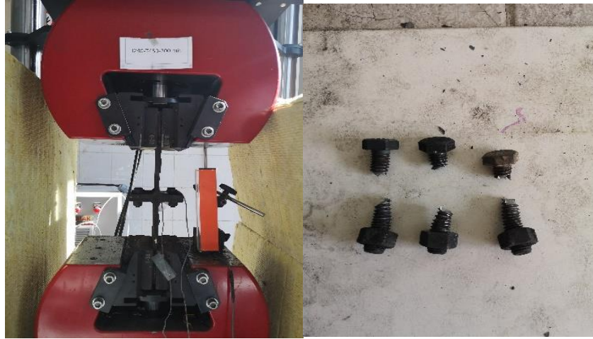
Şekil 3.49. I240-T450-200 \mu numunesinin çekme deneyi önce ve sonrası durumu.
