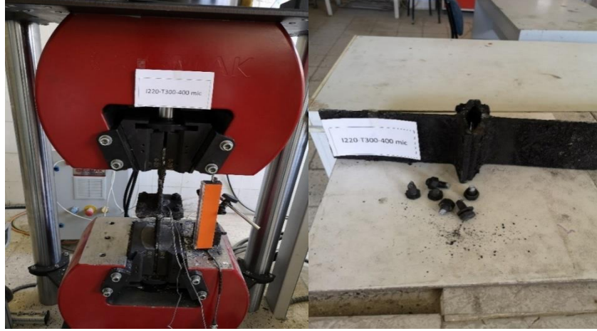
Şekil 3.33. I220-T300-400 \mu numunesinin çekme deneyi önce ve sonrası durumu.
