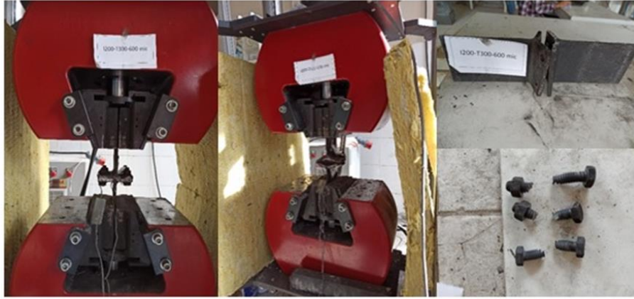
Şekil 3.18. IPE200-T300-600 \mu numunesinin çekme deneyi önce ve sonrası durumu.
