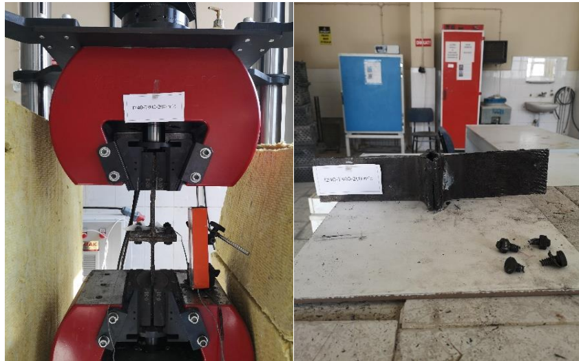
Şekil 3.48. I240-T300-200 \mu numunesinin çekme deneyi önce ve sonrası durumu.
