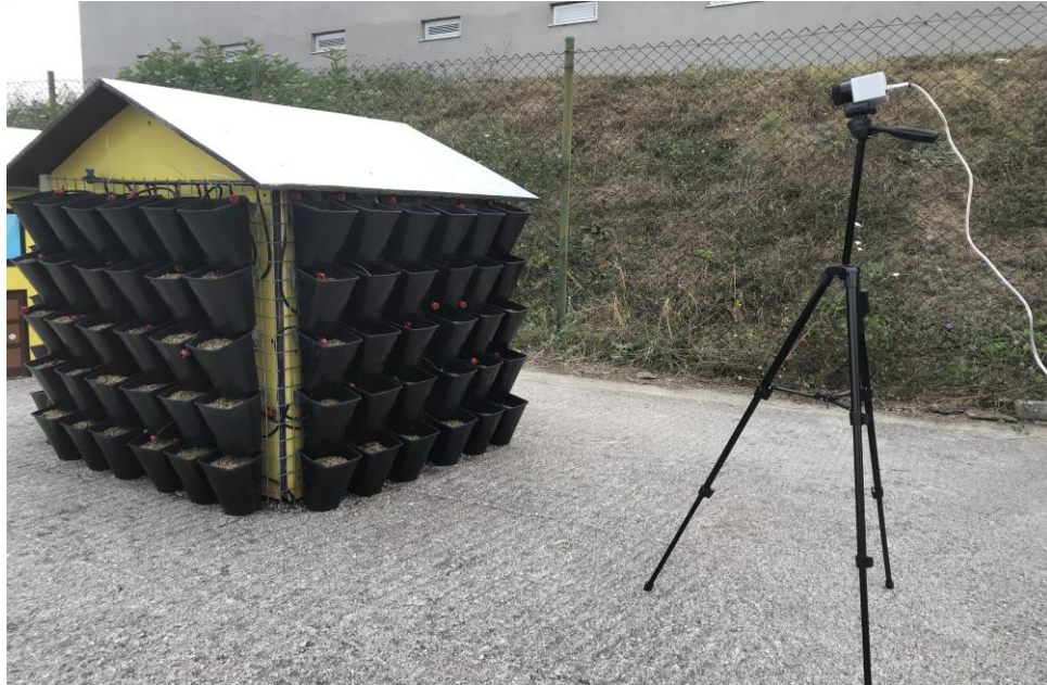
Şekil 3.11. Yeşil duvar sisteminin termal görüntülenmesi
