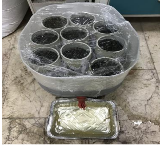
Şekil 3.7. Çelik halkalara doldurulmuş numunelerin drene edilmesi
