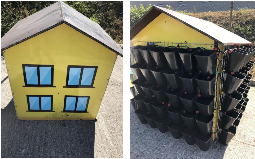
Şekil 3.8. Model bina ve yeşil duvar sistemi
