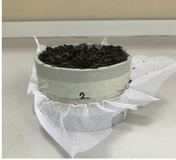
Şekil 3.5. Numunelerin çelik halkalara doldurulması
