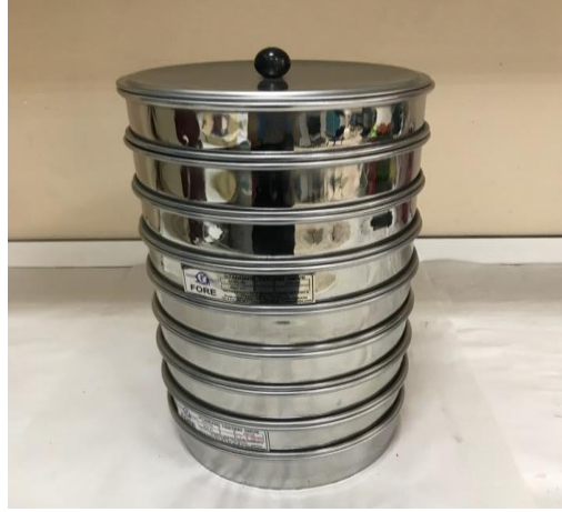
Şekil 3.3. Partikül boyut dağılımının belirlenmesinde kullanılan elek düzeneği
