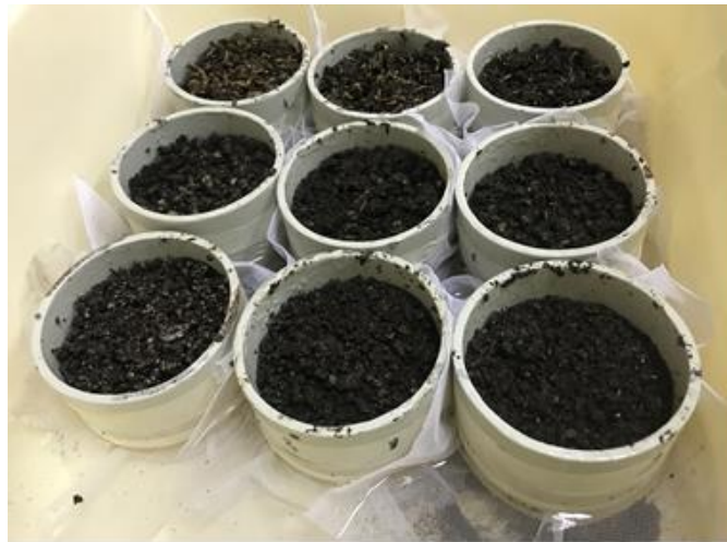
Şekil 3.6 Çelik halkalara doldurulmuş numunelerin suya doymun hale getirilmesi
