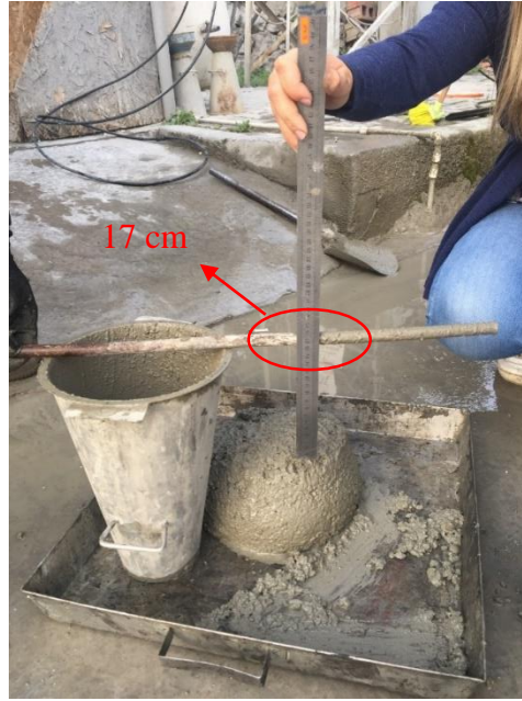
Şekil 3.10. OPC beton Slump Deneyi
