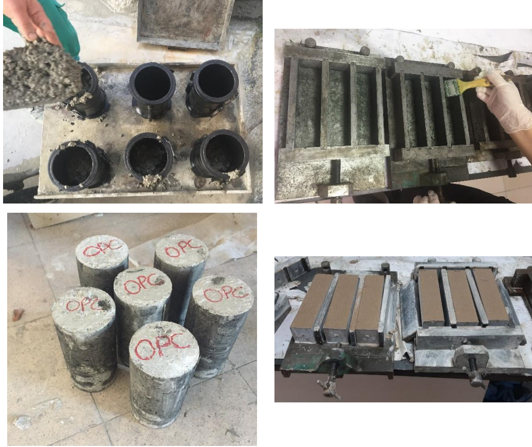
Şekil 3.11. GPC ve OPC taze betonlardan alınan numuneler
