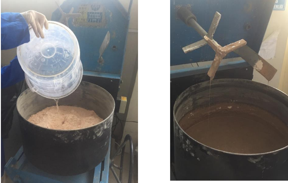
Şekil 3.5. Karışımı tamamlanmış geopolimer beton
