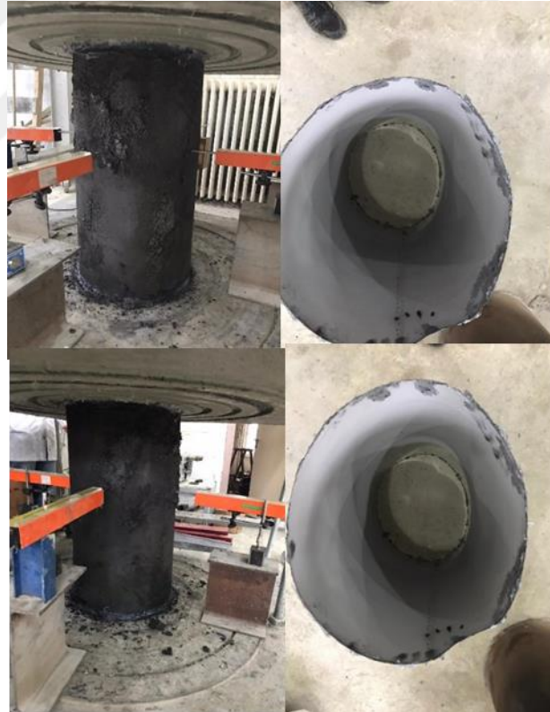
Şekil 3.8. 100-C450-O Numunesinin burkulma önce ve sonrası durumu
