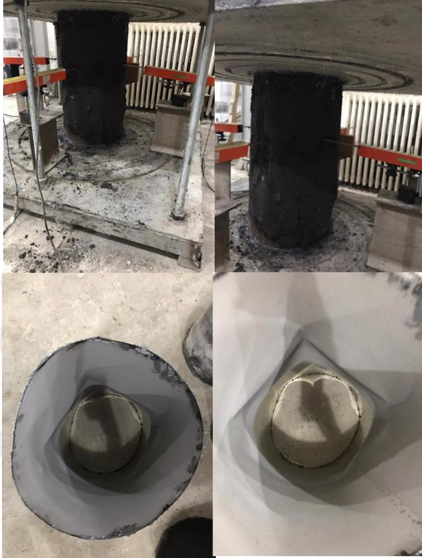
Şekil 3.14. 200-C450-O Numunesinin burkulma önce ve sonrası durumu
