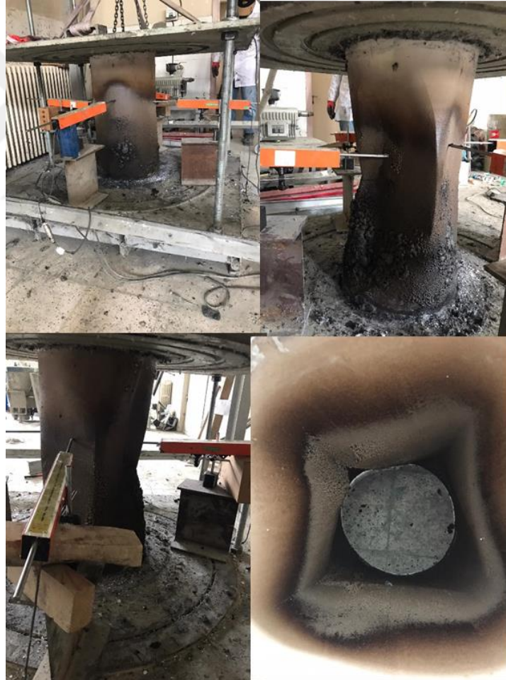
Şekil 3.39. 400-C300-I-O Numunesinin burkulma öncesi ve sonrası durumu
