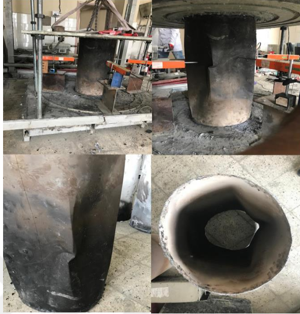
Şekil 3.27. 100-C300-I-O Numunesinin burkulma öncesi ve sonrası durumu
