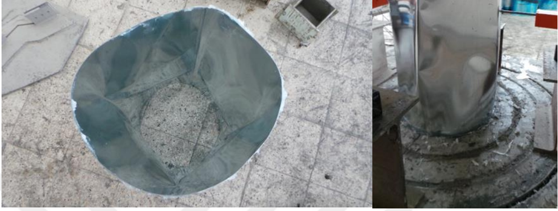
Şekil 3.51. İdeal modelin burkulma sonrası durumu
