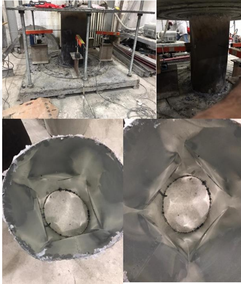
Şekil 3.13. 200-C300-O Numunesinin burkulma önce ve sonrası durumu
