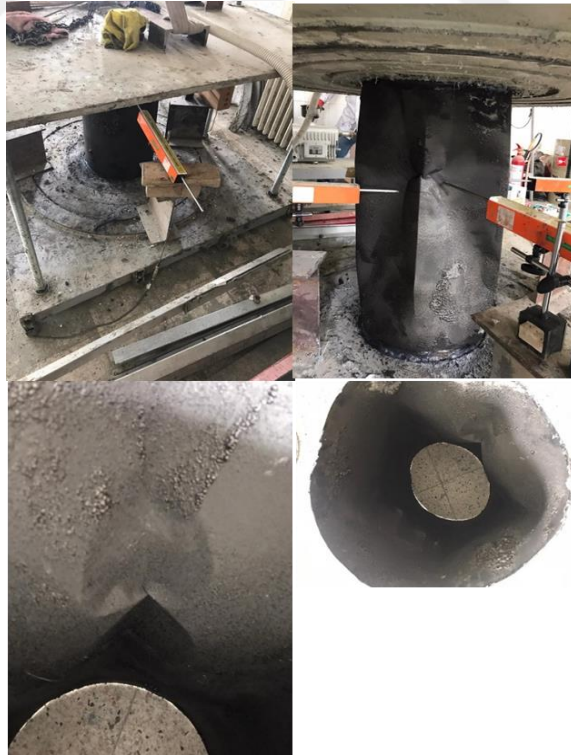
Şekil 3.28. 100-C450-I-O Numunesinin burkulma öncesi ve sonrası durumu
