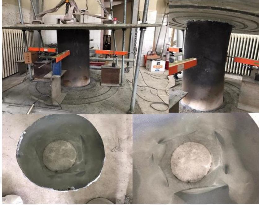
Şekil 3.7. 100-C300-O Numunesinin burkulma önce ve sonrası durumu
