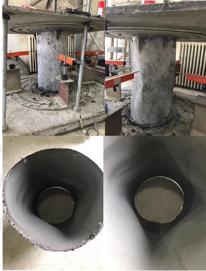
Şekil 3.9. 100-C600-O Numunesinin burkulma önce ve sonrası durumu
