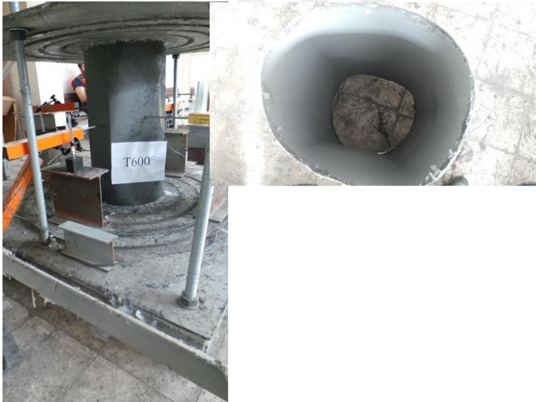
Şekil 3.50. C600 Numunesinin burkulma sonrası durumu
