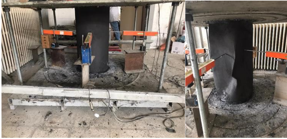
Şekil 3.40. 400-C450-I-O Numunesinin burkulma öncesi ve sonrası durumu
