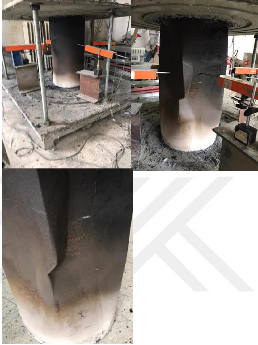
Şekil 3.33. 200-C300-I-O Numunesinin burkulma öncesi ve sonrası durumu
