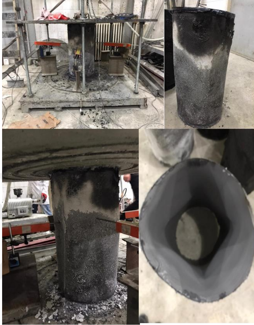
Şekil 3.15. 200-C600-O Numunesinin burkulma önce ve sonrası durumu
