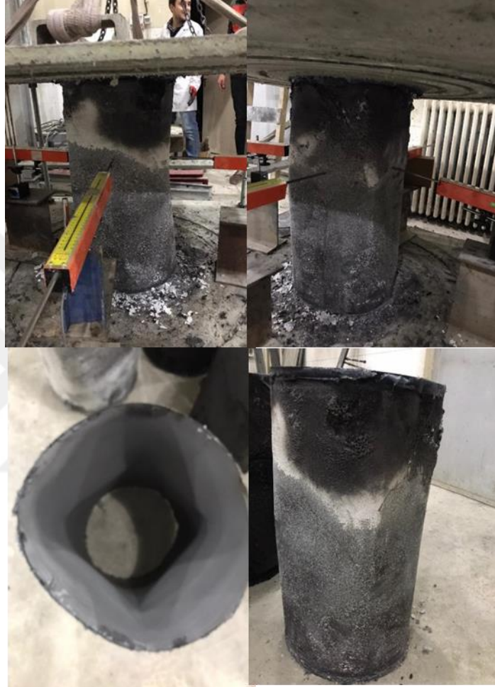
Şekil 3.19. 400-C300-O Numunesinin burkulma önce ve sonrası durumu
