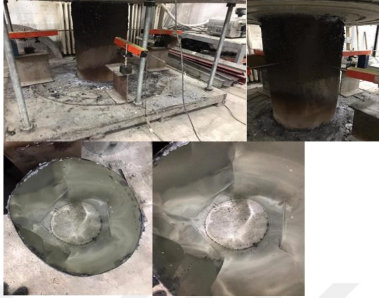
Şekil 3.20. 400-C450-O Numunesinin burkulma önce ve sonrası durumu
