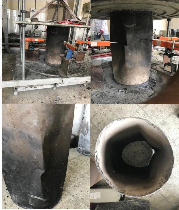
Şekil 3.41. 400-C600-I-O Numunesinin burkulma öncesi ve sonrası durumu
