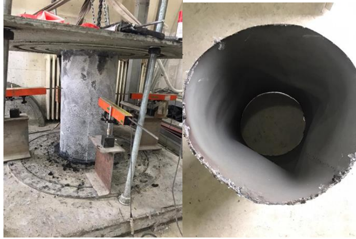
Şekil 3.29. 100-C600-I-O Numunesinin burkulma öncesi ve sonrası durumu
