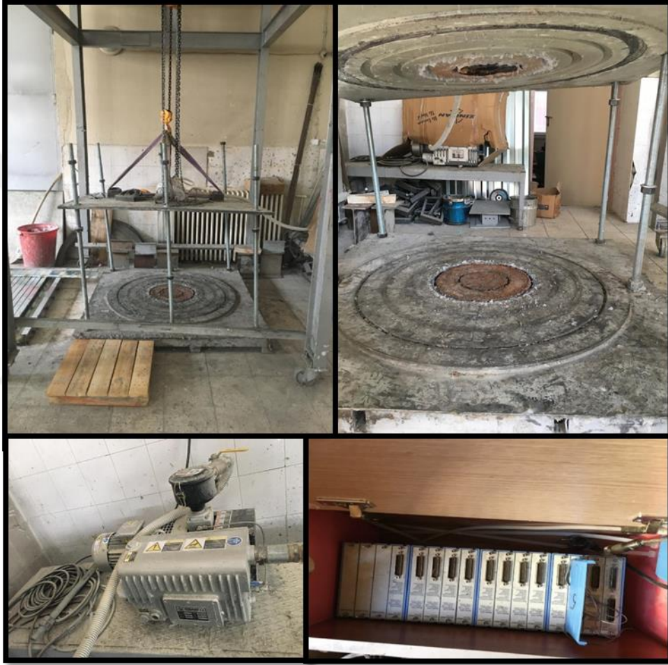
Şekil 2.7. Deney düzeneği, vakum pompa ve data logger
