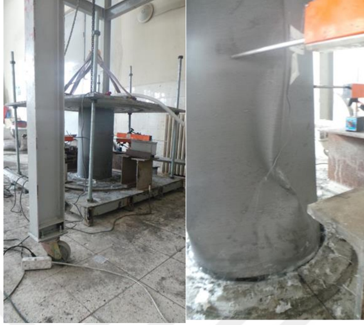
Şekil 3.49. C450 Numunesinin burkulma sonrası durumu
