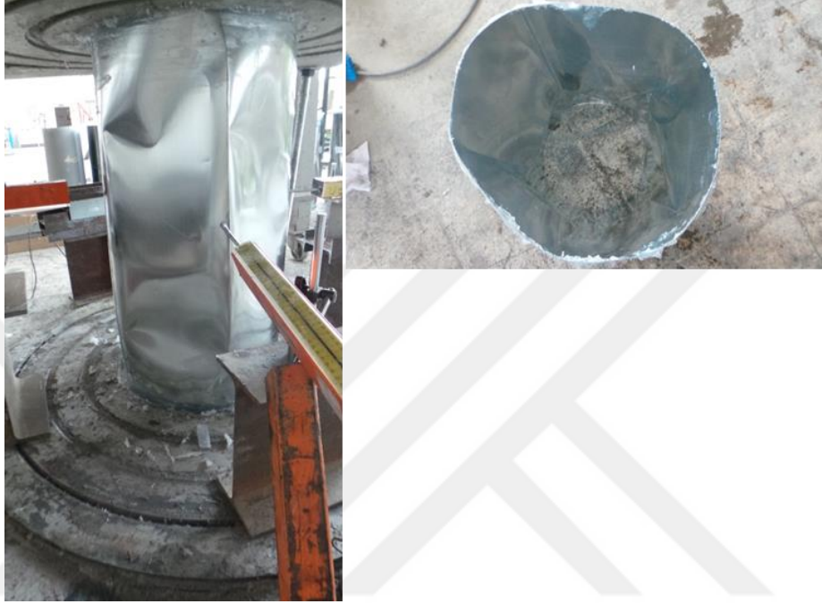
Şekil 3.48. C300 Numunesinin burkulma sonrası durumu
