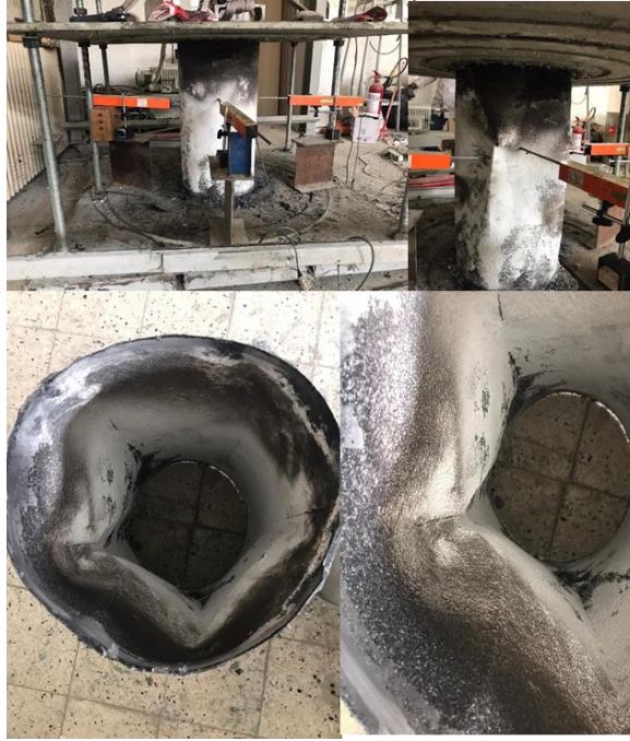
Şekil 3.35. 200-C600-I-O Numunesinin burkulma önce ve sonrası durumu
