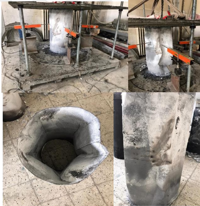
Şekil 3.21. 400-C600-O Numunesinin burkulma önce ve sonrası durumu
