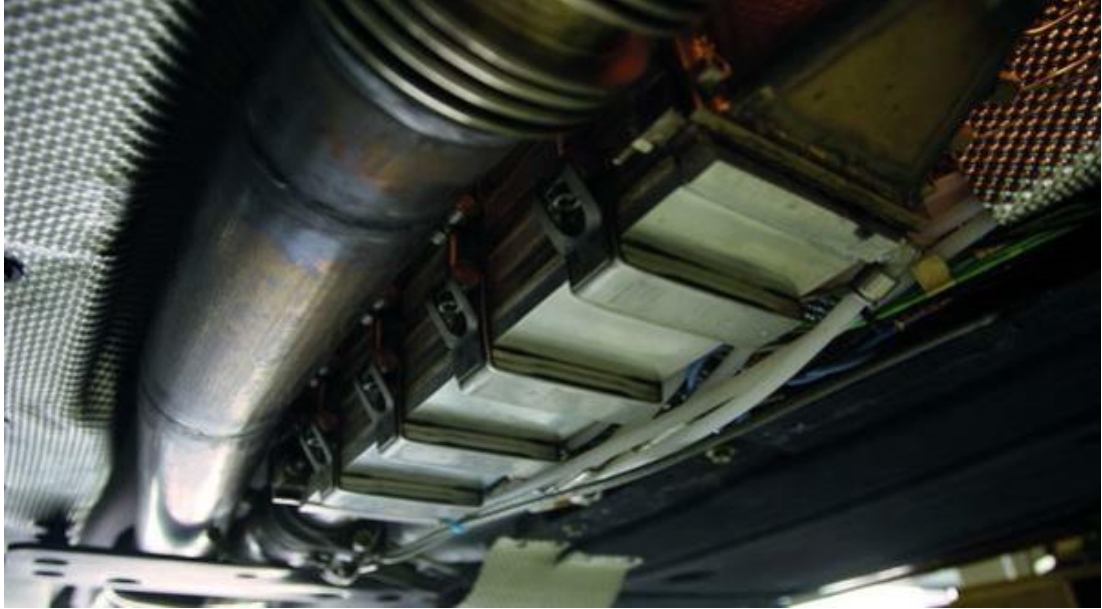
Şekil 2.12. BMW marka otomobilin atık ısı termoelektrik jeneratörü [56]
