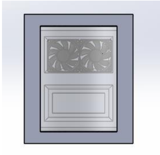
Şekil 3.4. Platform üstü vinç kabini klima için elektrik panosu
