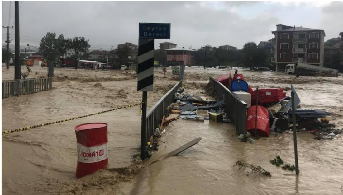
Şekil 2.3. Sakarya, Kaynarca, Seyren deresi çevresinde uygunsuz malzeme stoğunun taşkın tesirini arttırıcı etkisi
