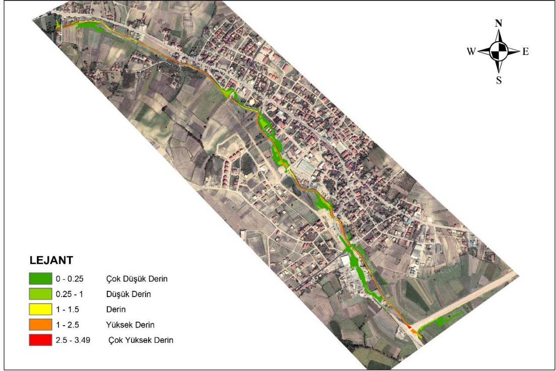
Şekil 6.42. Seyren deresi havzası için Q 25 taşkın derinlik haritası
