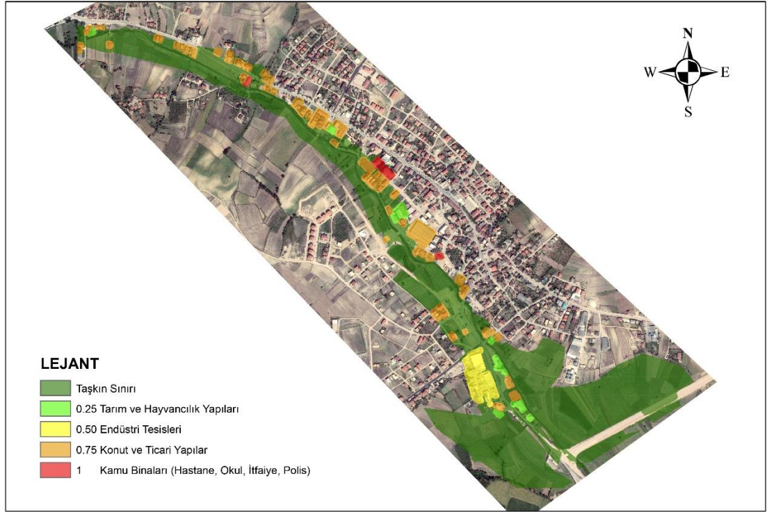
Şekil 6.59. Seyren deresi maksimum taşkın sınırlarındaki yapı kullanım katsayısı
