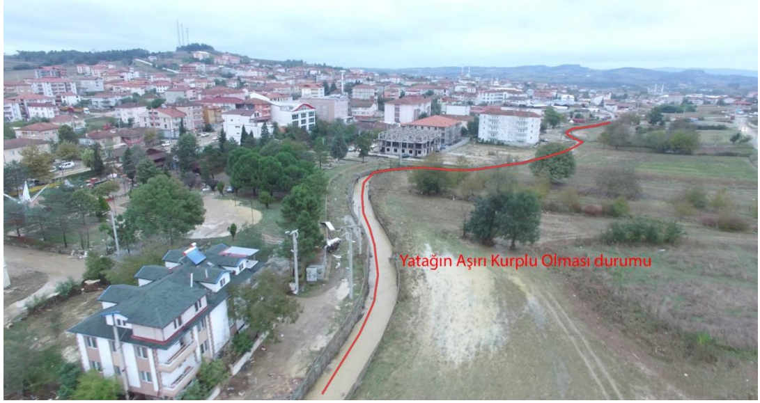
Şekil 2.1. Sakarya, Kaynarca, Seyren deresinde dar kesitli aşırı kurplu yatak
