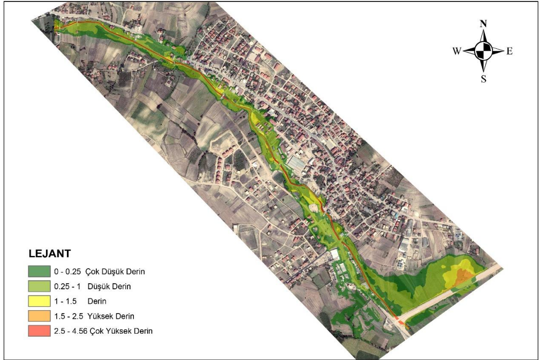
Şekil 6.25. Seyren deresi havzası için Q_{500} taşkın derinlik haritası
