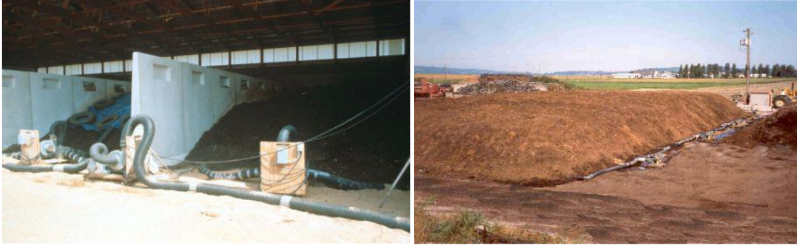
Şekil 26: Havalandırmalı Statik Yığın Yöntemi
