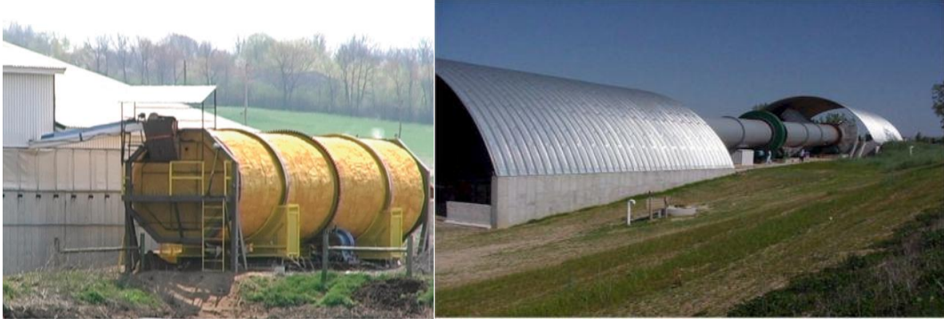
Şekil 27: Reaktörde Kompostlaştırma Yöntemi
