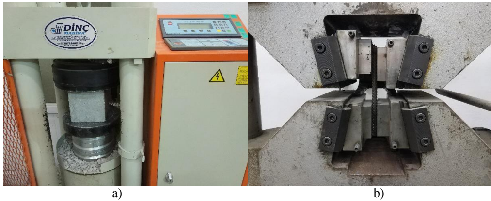
Şekil 5.5. a) Beton basınç dayanım testi b) Donatı çekme testi
