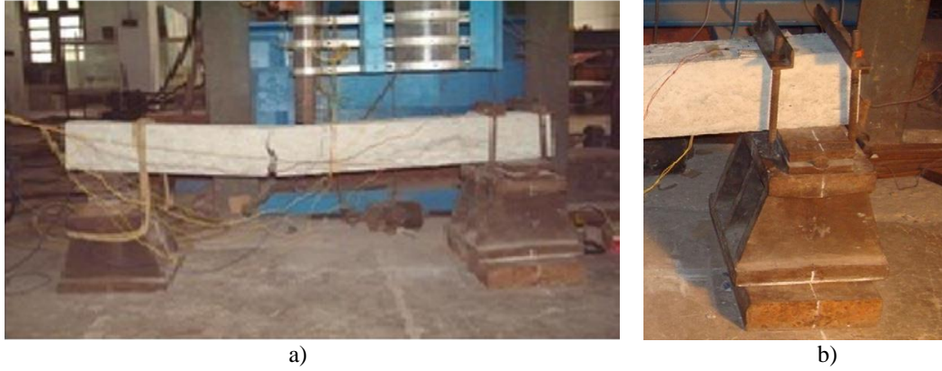
Şekil 3.10. a) Çarpma deneylerinde kullanılan deney düzeneği b) Mesnet detayı
