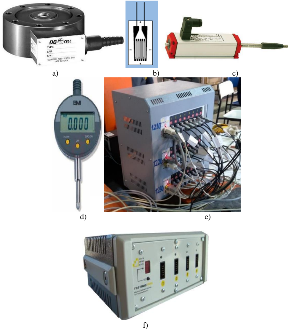
Şekil 5.13. a) Yük hücresi b) Gerinim pulu c) Potansiyometre d) Mititoyo (yerdeğiştirme ölçer) e) 32 kanallı veri toplama sistemi f) 4 kanallı veri toplama sistemi
