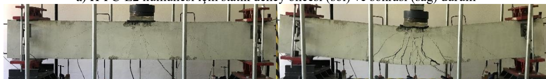
b) H-FC-E2-2 numunesi için statik deney öncesi (sol) ve sonrası (sağ) durum
