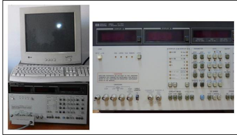
Şekil 3.11. C-V ve G/\omega -V ölçümlerinde kullanılan Empedans Analizörü.
