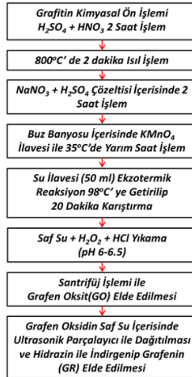
Şekil 5.1. Grafen oksit üretim adımları.
