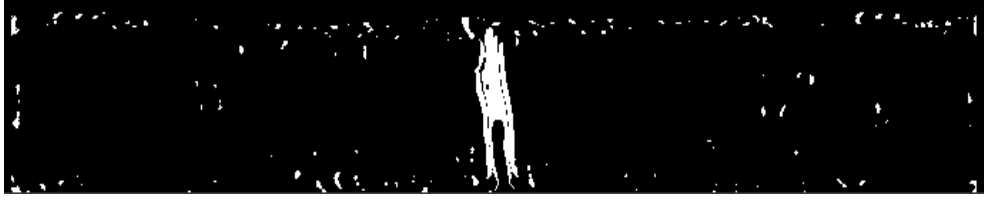
Şekil 5.15. Eşik değeri uygulanmasıyla elde edilen gürültü içeren kusur bölgeleri ikili (binary) görüntüsü.
