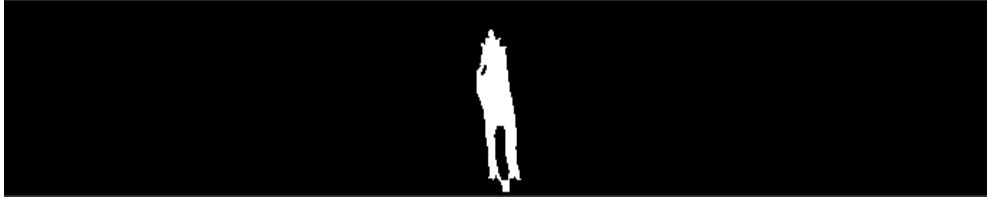
Şekil 5.17. Gürültüden arındırılmış kusur bölgelerini gösteren ikili (binary) görüntü.
