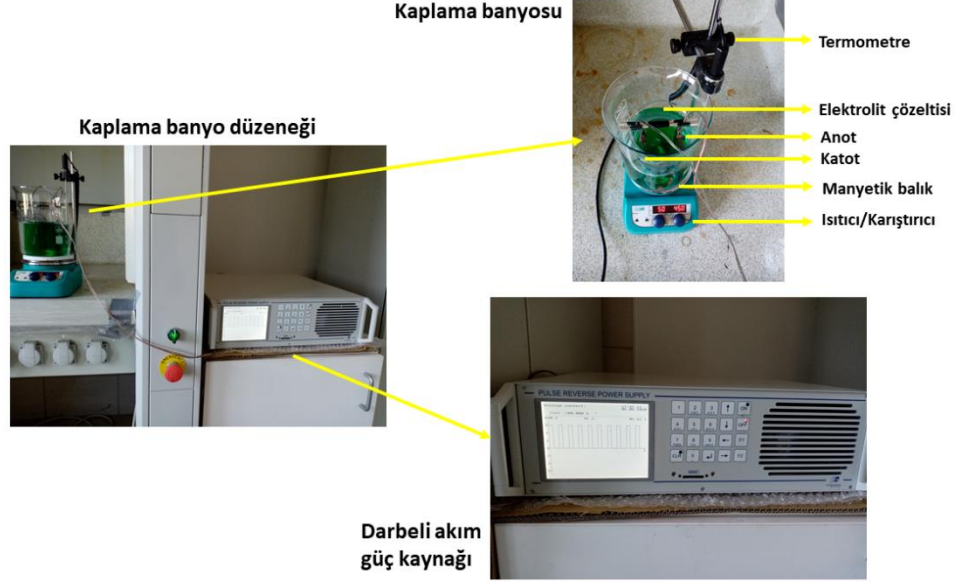
Şekil 5.2. Ni-B-TiN kompozit kaplama banyosunun düzeneği
