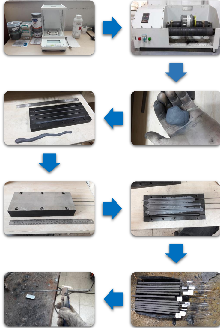
Şekil 3.6. Elektrot üretimi akış şeması ve üretilen elektrotlar
