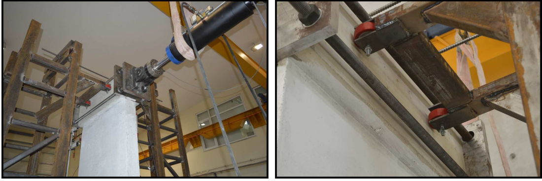
Şekil 3.20. Deney düzeneği düzlem dışı destek çerçevesine ait tekerlek tasarımı
