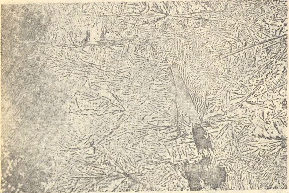
Şekil. 7. — Katılaşıma eksenine paralel kesilmiş Al-% 17 Si, alaşımasının optik mikroyapısı. Katılaşıma yönü sağdan sola olup alaşım aniden soğutulmuş ve düzensiz katı - sıvı arayüzeyi açığa çıkarılmıştır ( R=95 \mu\text{m}/\text{sn} , \times 190 , G=125^\circ\text{C}/\text{cm} ).
