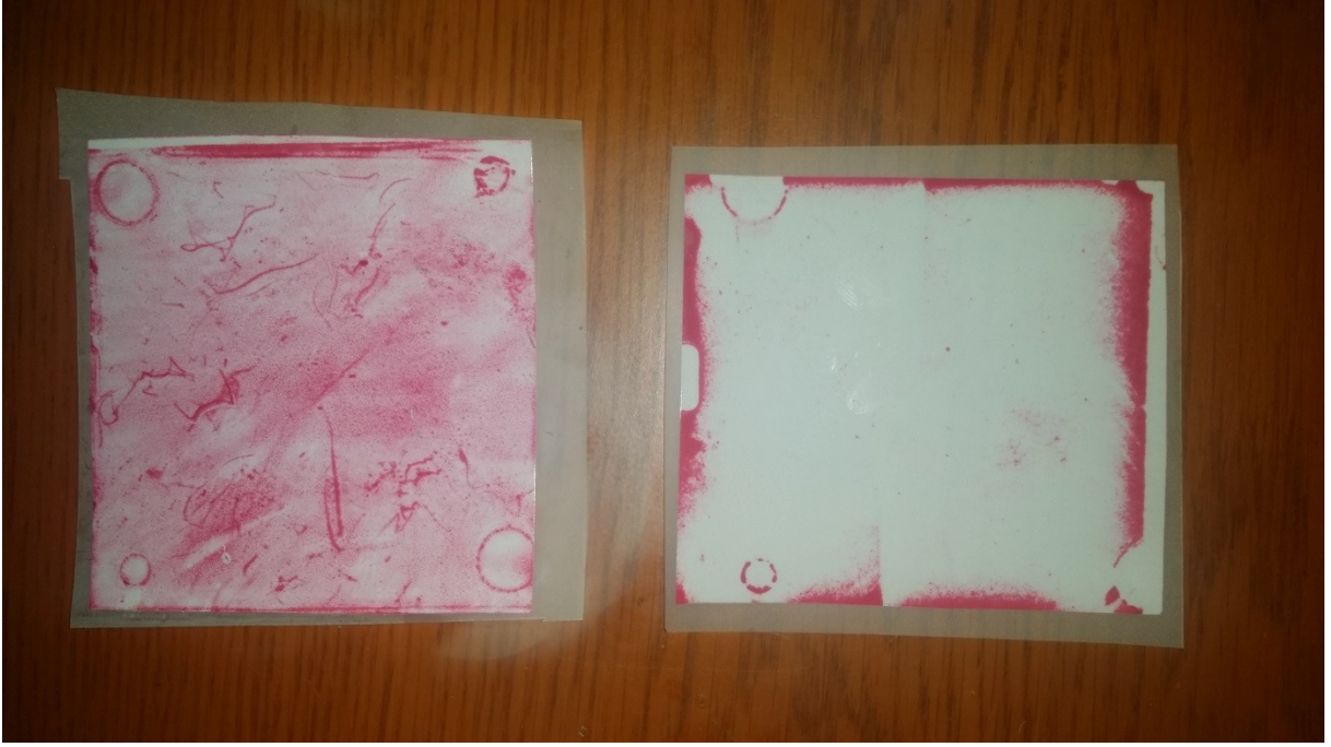
Şekil 14. Basınç dağılım ölçümleri; modifikasyon öncesi (sağda) ve sonrası (solda)
