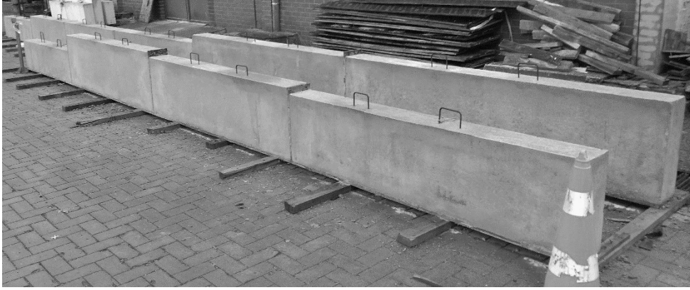
Şekil 17. Kalıbrı sökülmüş deney numuneleri.
