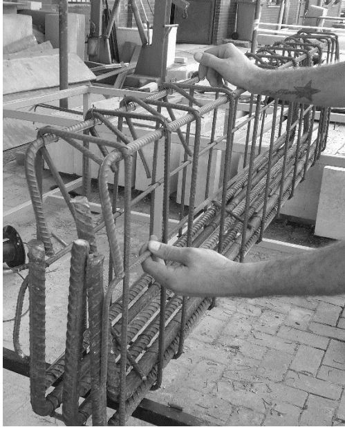
(a) Donatıların hazırlanması (a) ve donatılara yapıştırılan gerinim pulları (b).
