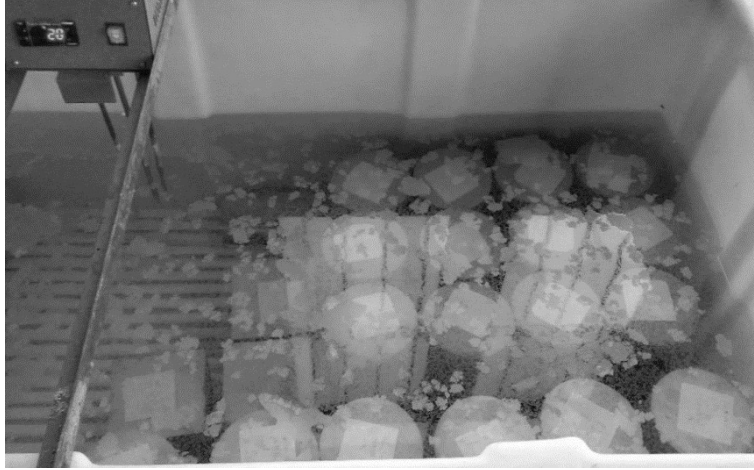
Şekil 19. Numunelerin kür havuzunda bekletilmesi.
