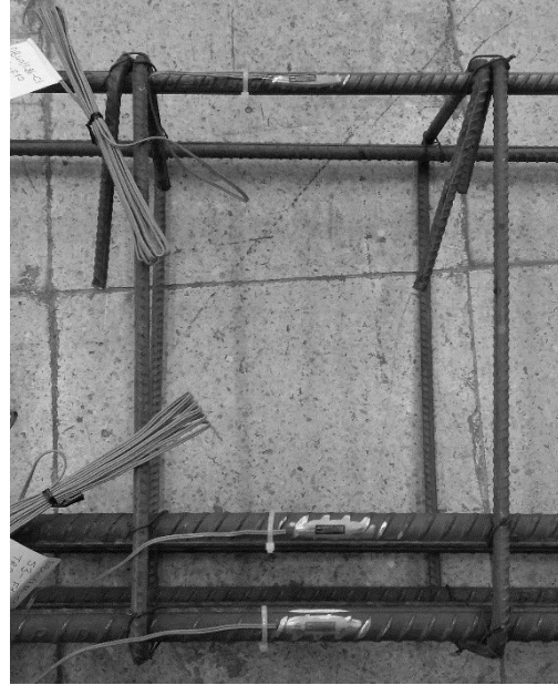
(a) Donatıların hazırlanması (a) ve donatılara yapıştırılan gerinim pulları (b).
