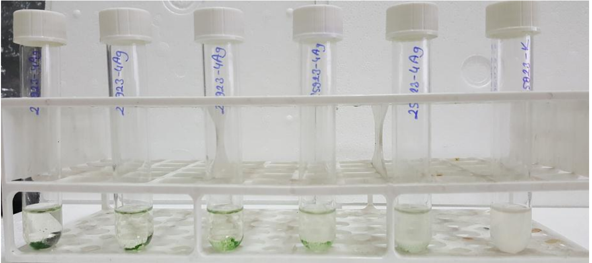
Şekil 3.111. Bileşik 4+Ag S.aureus MİK deneyi sonuçları (tüplerdeki 4+Ag bileşiği konsantrasyonu soldan sağa: 100-50-25-12,5-6,25-0 µg/mL; K=kontrol)
