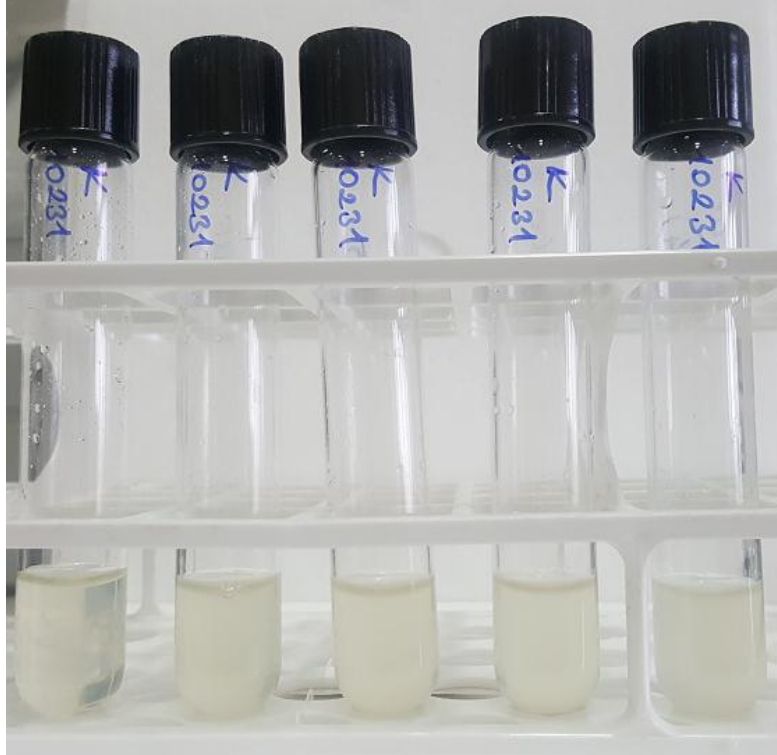
Şekil 3.137. Kontrollerin C.albicans MİK deneyi sonuçları (tüplerdeki DMF miktarı soldan sağa: 100-50-25-12,5-6,25-0 µg/mL konsantrasyon değerindeki ftalosiyanın bileşiklerinin çözücü miktarları ile eşdeğer düzeyde olacak şekilde ayarlanmıştır)
