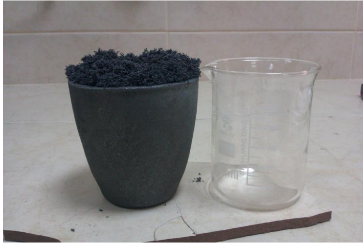
Şekil 2.7. Ön işlem sonrası grafitin görüntüsü.
