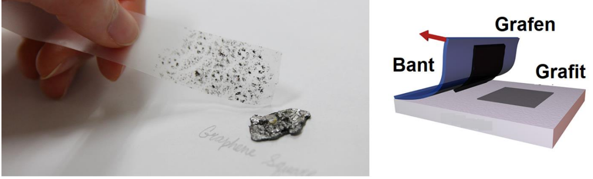
Şekil 2.3. Katman ayırma yöntemi ile grafen sentezi [98].
