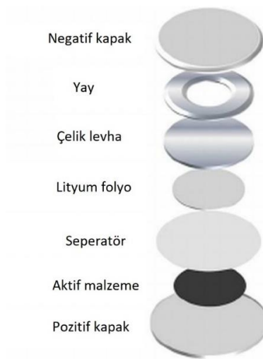
Şekil 4.18. CR2016 düğme tipi hücrelerin birleştirilmesinin şematik gösterimi
