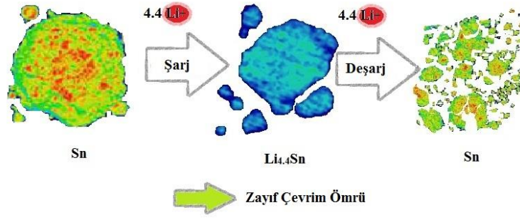
Şekil 5.1. Sn anotunun şarj/deşarj sırasında bozunması.
