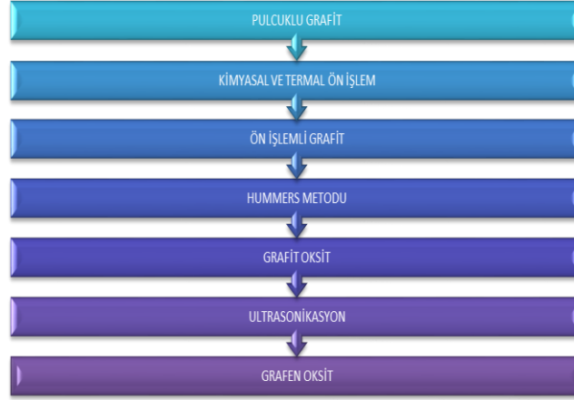
Şekil 2.1. Kimyasal yöntem ile grafen oksit üretim basamakları.
