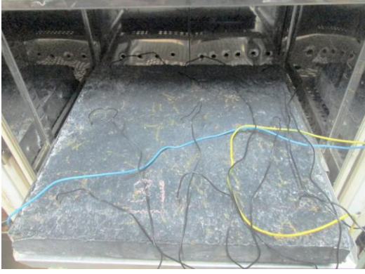
Soğutucunun içerisinde plaka numunesinin yüzeyinde termometre bağlantıları.
