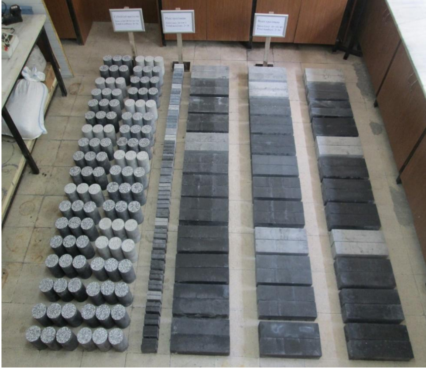
Şekil 2.10. Numunelerin oda sıcaklığında kurutulması.
