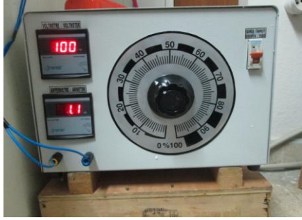
0 ile 220 V arasında ayarlanabilir varyak.
