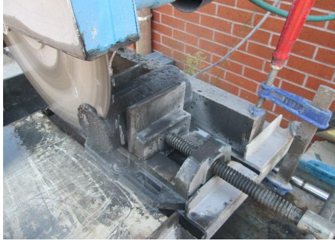
Şekil 2.9. Silindir numunelerin pürüzlü taraflarının kesilmesi.
