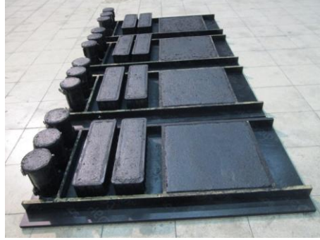
ATE ieren numune gruplarının kalıplanması.
