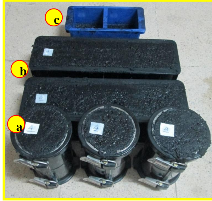
Şekil 2.7. Kalıplanmış numune örnekleri; a) basınç ve ED, b) eğilme deneyi ve c) çarpma deney numuneleri.
