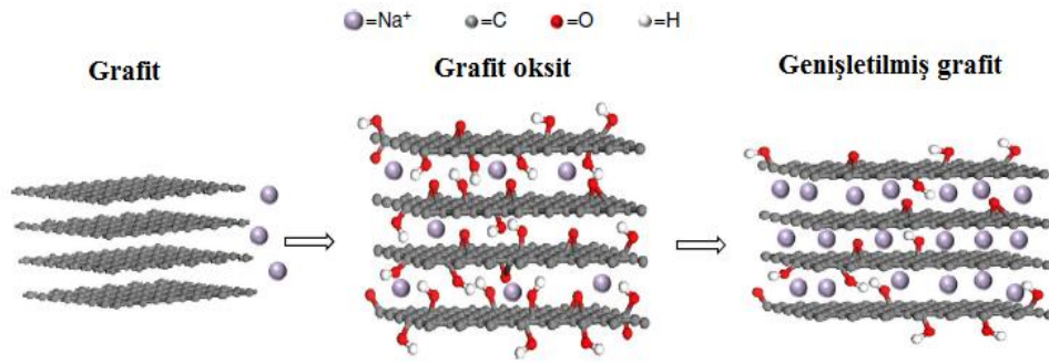
Şekil 2.2. Grafit esaslı malzemelerde genişletilmiş grafitin gösterimi [22].
