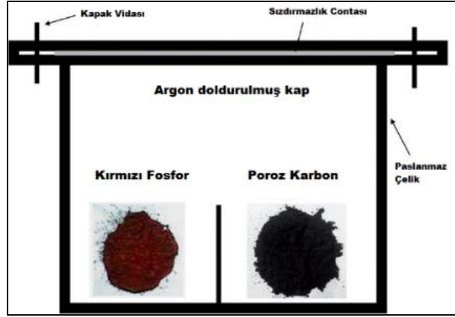
Şekil 3.2. Termal buhar biriktirme yöntemi ile P@Karbon kompozitlerinin şematik olarak sentezi [35].
