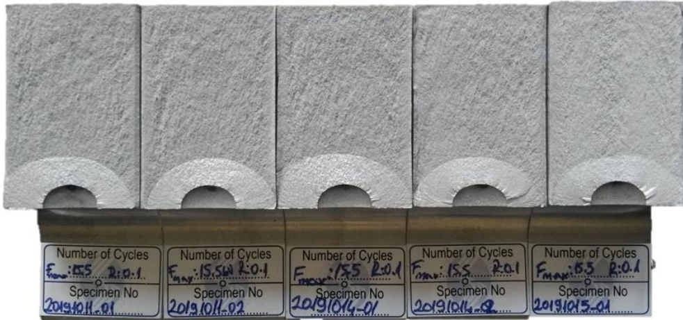
Şekil 3.5.26. Sabit genlik altında üç boyutlu çatlak ilerleme deneyleri sonrası kırılma yüzeyleri (R= 0.1)
