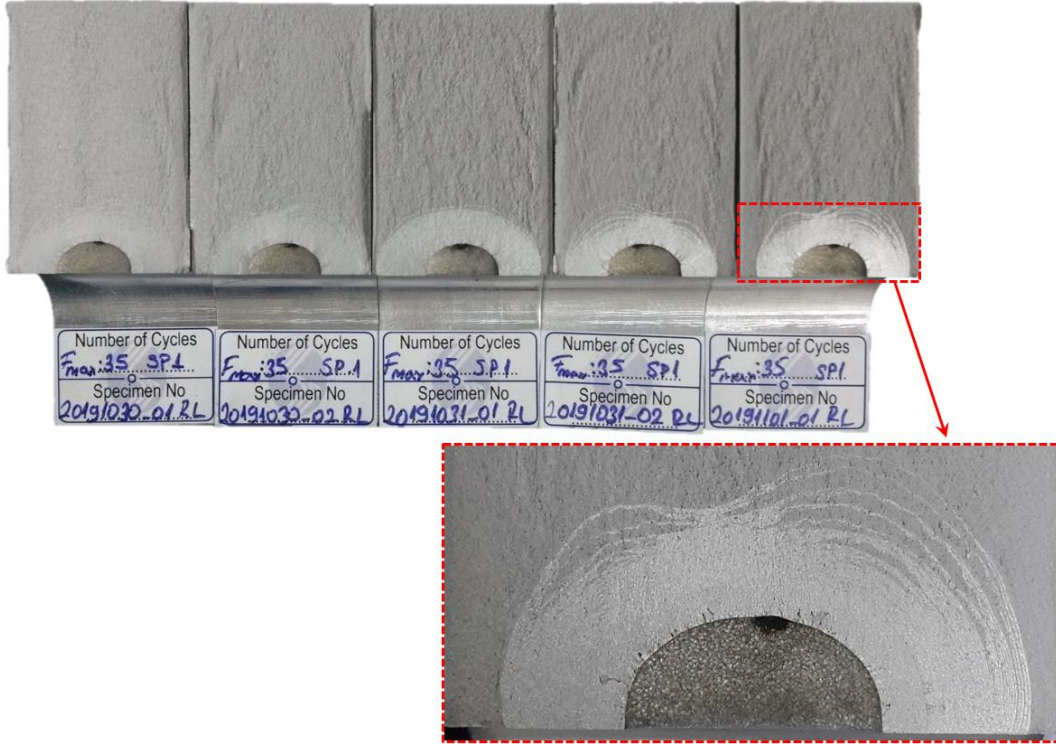
Şekil 3.5.36. Spektrum 1 yüklemesi altında üç boyutlu çatlak ilerlemesi sırasında oluşan simetri bozukluğu
