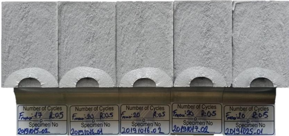
Şekil 3.5.27. Sabit genlik altında üç-boyutlu çatlak ilerleme deneyleri sonrası kırılma yüzeyleri (R= 0.5)
