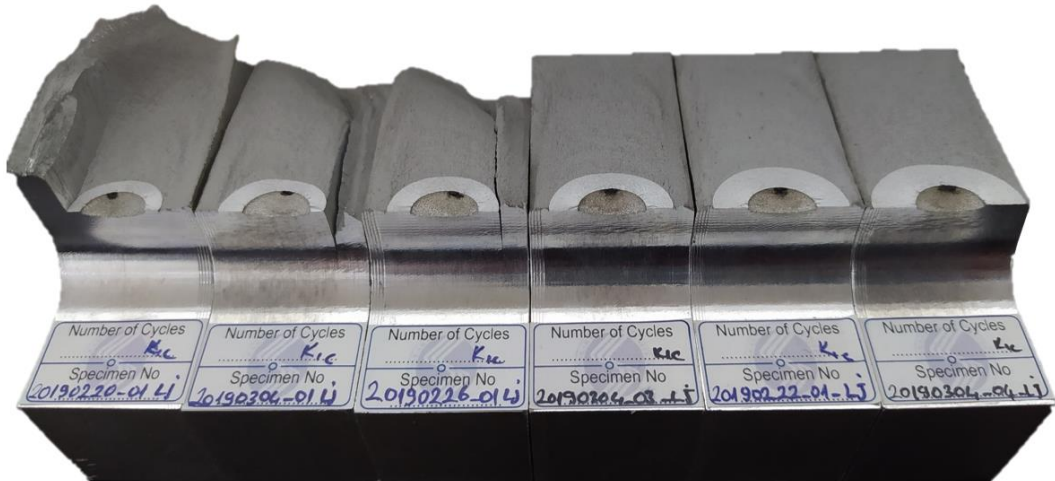
Şekil 3.5.21. Farklı çatlak boyutlarında kırılma testi yapılmış Lee James numuneleri
