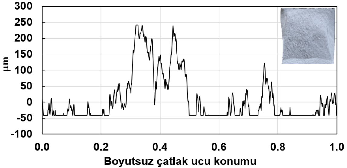
Şekil 3.5.38. CT numunesi üzerinden alınan yüzey pürüzlülük ölçümü
