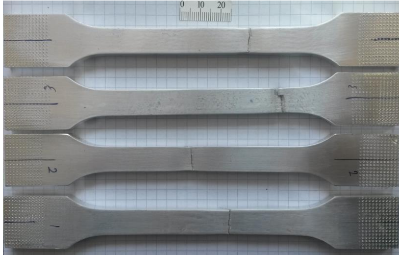
Şekil 3.4.2. Çekme testi sonrasında Alüminyum 7075-T651 malzemenin görüntüsü
