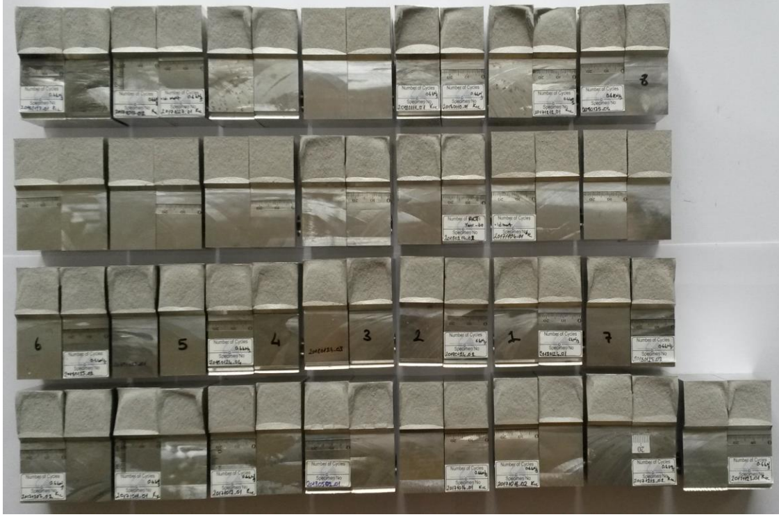
Şekil 3.4.9. Kırılma tokluğu deneylerinde kullanılan numunelerin üstten görünüşleri
