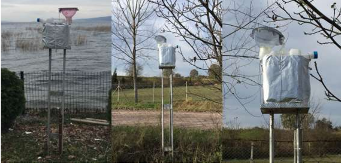
Şekil 7. Havadan numune alma ekipmanı (bulk birikim örnekleyicisi)
