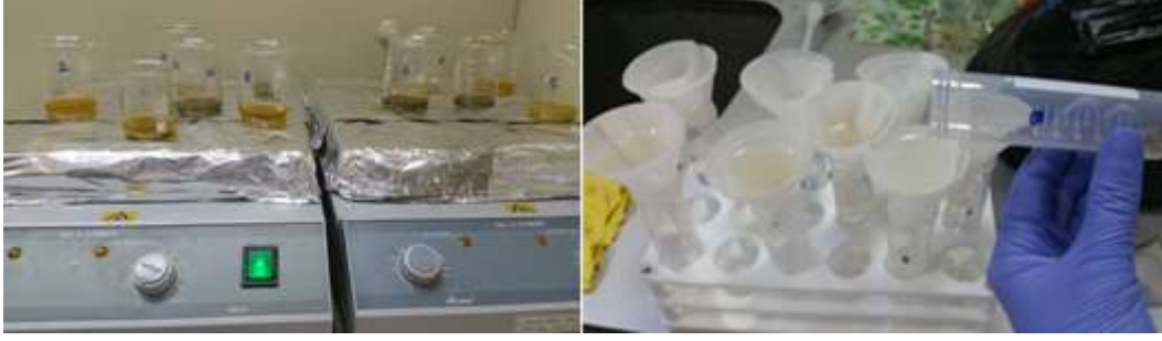
Şekil 14. Numunelerin kral suyu ile çözündürülmesi ve süzülmesi
