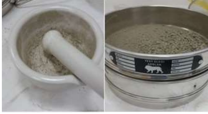
Şekil 9. Numunelerin öğütülmesi ve elenmesi
