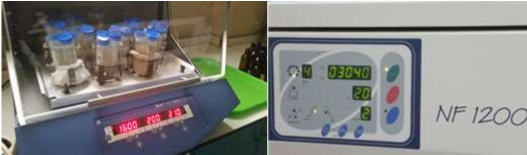
Şekil 13. Numunelerin BCR yöntemi ile çözündürülmesi (çalkalama ve santrifüjleme)
