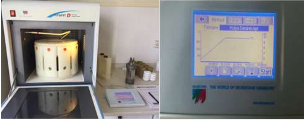
Şekil 11. Numunelerin mikrodalga cihazında çözünürleştirilmesi
