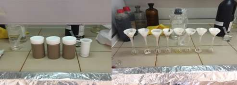
Şekil 12. Çözündürülme işlemi sonrası numunelerin süzülmesi
