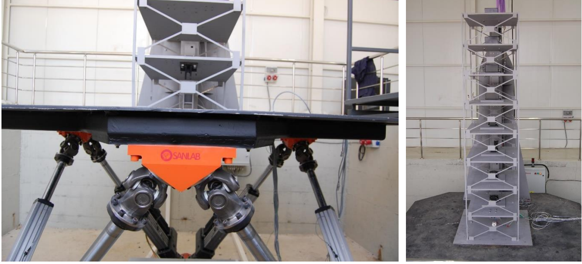
Şekil 78. Sarsma tablası deney düzeneği ve 8 katlı ölçeklenmiş yapı modeli
