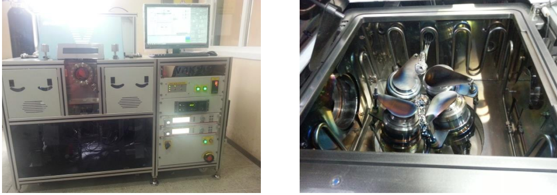
Şekil 8. Sakarya Üniversitesi Merkez Laboratuvarı'nda kurulu bulunan VAKSİS Angora model Magnetron Sputtering Deposition kaplama sisteminin dış ve iç görünüşü.
