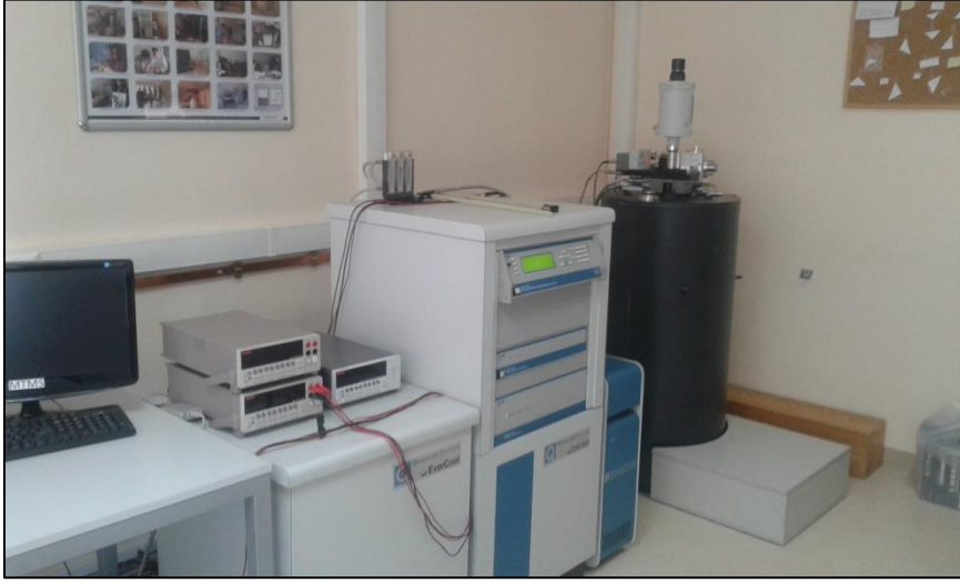
Şekil 30: GTÜ PPMS Laboratuvarı'nda kurulu bulunan VSM sistemi.
