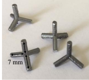
Şekil 70. Basma deneyinde kullanılan ayırık metal tripod takviye numunesi.
