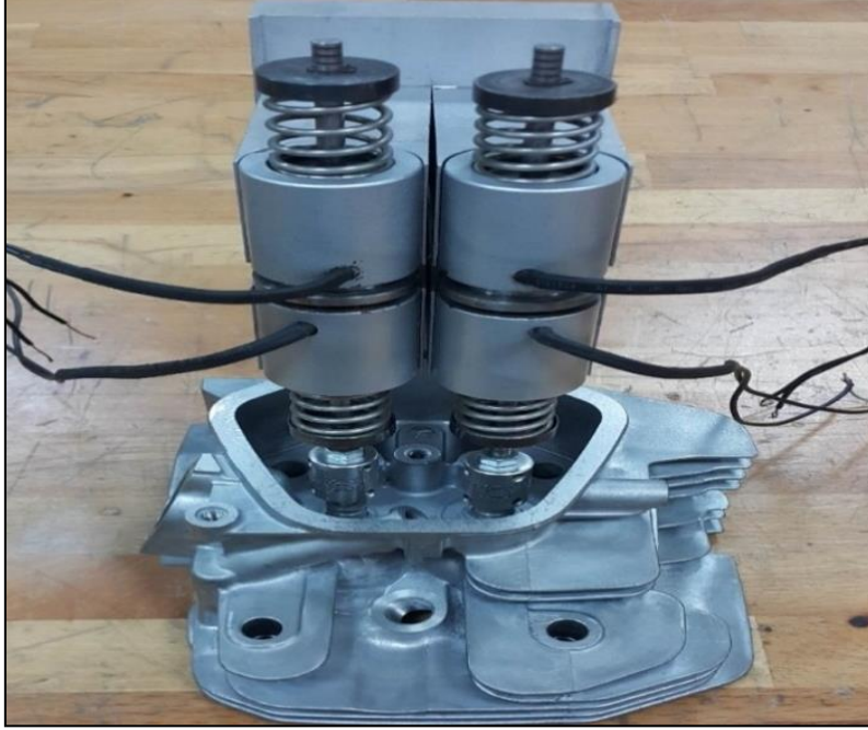
Şekil 22. ESM'nin silindir kapağına montajı
