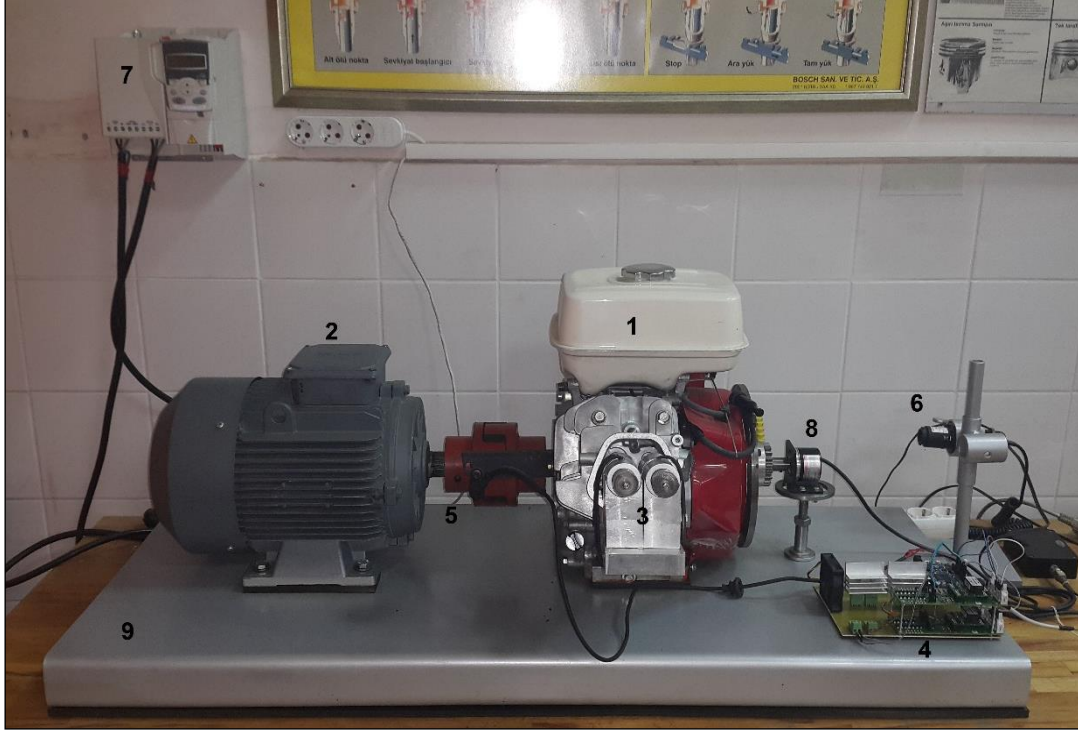
Şekil 3. Deney düzeneğinin genel görünümü (1.Yakıt Tankı 2.Elektrik Motoru 3.ESM 4. Kontrol ve Sürücü Devresi 5.ÜÖN Sensörü 6.Optik Sensör 7.Elektrik Motoru Sürücüsü 8.Enkoder 9.Motor Test Tezgahı)
