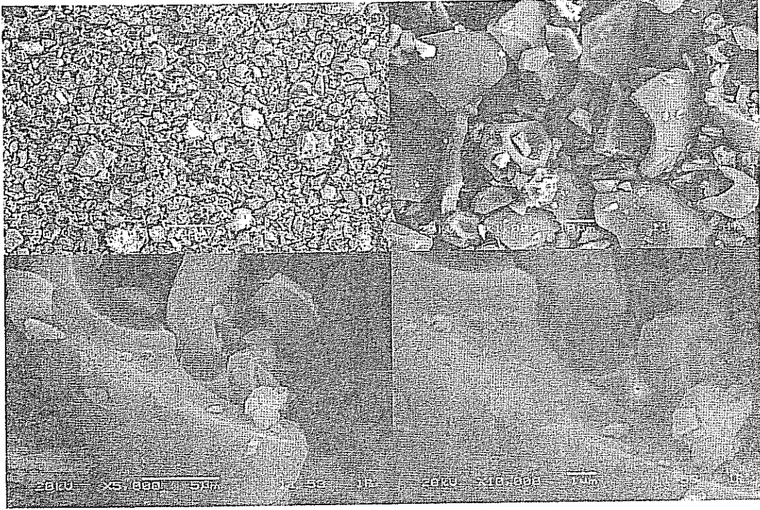
Şekil 5.15. Ham valeks' in taramalı elektron mikroskobu (TEM) ile elde edilen görüntüleri
