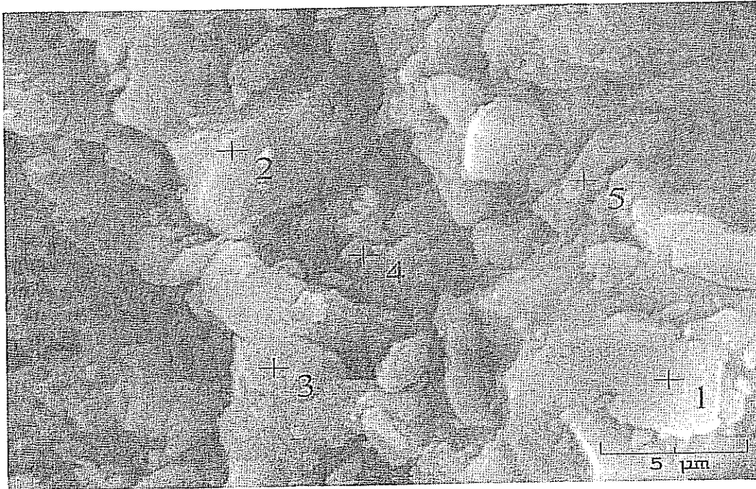
Şekil 5.6. 38 \mu m-53 \mu m tane boyutundaki kebrako2 reçinesinin enerji dağıtıcı spektrofotometre ile elde edilen görüntüleri
