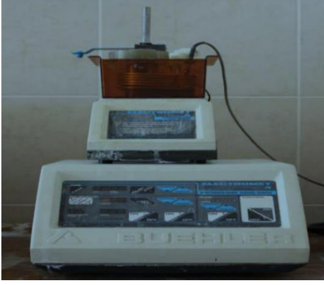
Şekil 3.3 Metalgrafik incelemede kullanılan elektrolitik parlatma ve dađlama cihazı
