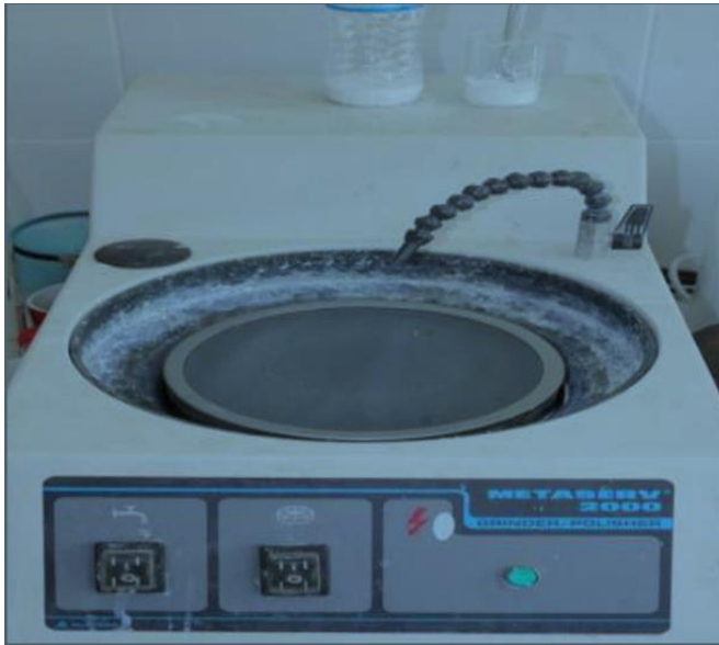
Şekil 3.2 Metalografik incelemede kullanılan zımparalama cihazı
