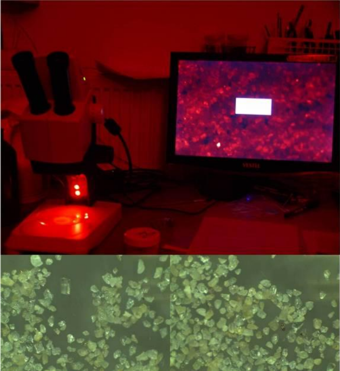
Şekil 10 Leica görüntülemeli binoküler mikroskop ile kırmızı ışık ortamında örnek incelenmesi ve fotoğraflanması
