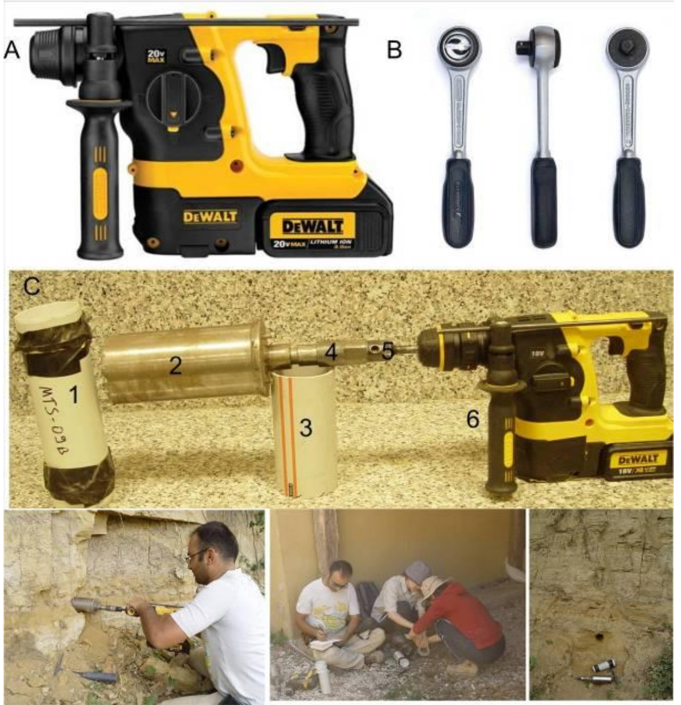
Şekil 7 Örneklem sistemi A) DeWalt 20V Lithium Ion (3.0 Ah) 3 seçenekli kırıcı matkap B) Elle uygulama için torklu cırcır lokma kolu (ratchet wrench) detay C) karotiyer sistemi: 1) örnek içeren kapatılmış PVC boru 2) karotiyer 3) 75 mm PVC boru 4) ara bağlantı 5) matkap bağlantısı 6) matkap. D) Araziye örneklem aşamaları: delme, paketlenme ve fotoğrafçılık
