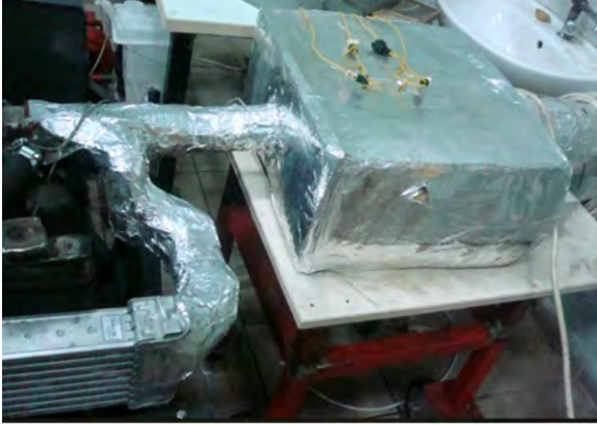
Şekil 3.2. Sıcaklık kontrol ünitesi
