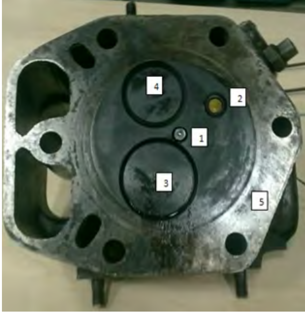
Şekil 3.13. Silindir gaz basınç sensörü ve GDI enjektörün silindir kapağına montajı
