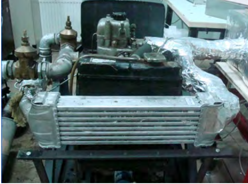
Şekil 3.3. Soğutulmuş dış EGR sistemi
