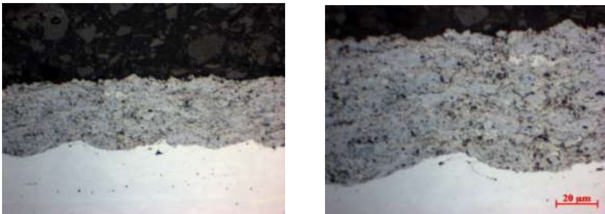
Şekil 3. 38. Geri kazanılan tozlardan üretilen kaplamaların optik mikroskop görüntüleri
