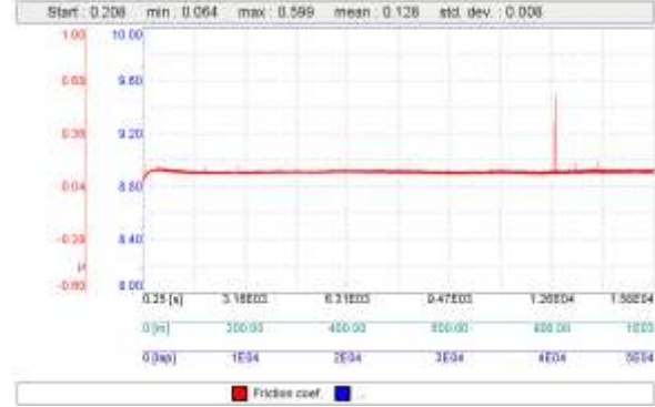
Şekil 3.45. Ticari tozdan üretilen kaplamaların sürtünme katsayısı
