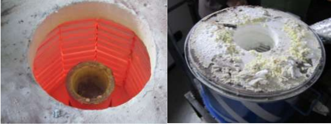
Şekil 3.6. Geri kazanım sürecinde fırın üzerinde biriken çinko oksit (buharlaştırma sonrası)
