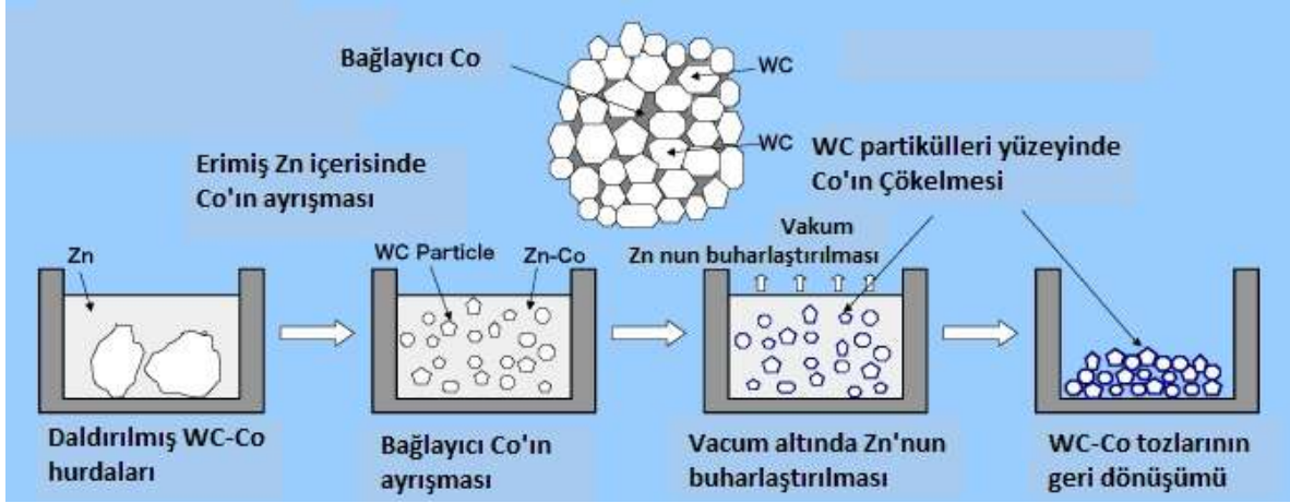
Şekil 3.3. Çinko banyosunda geri kazanım sürecinin adımları.
