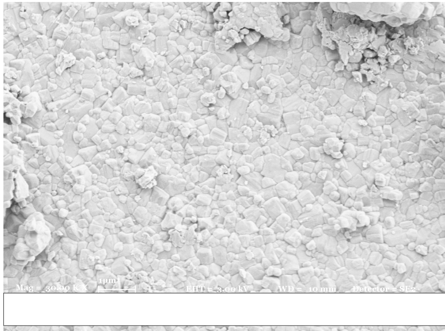
Şekil 23. (a) %5 Gd katkılı \text{BiFeO}_3 tozunun tane yapısını gösterir 30K büyütme SEM mikrografı. Tane boyutu yaklaşık 0.25 ila 0.5 mikron aralığındadır, ayrıca 100-200 nm boyutlarda küçük taneler de dikkati çekmektedir, saf \text{BiFeO}_3 tozunun tane boyutuna oranla belirgin bir tane küçülmesi mevcuttur. Bu mikrograf ayrıca Gd katkılı numunelerde tanelerin büyük topaklar halinde değil küçük topaklar halinde bir araya geldiğini de ortaya koymaktadır. (b) %5 Sm katkılı toz. Tane boyutu burada da 100-400 nm civarı olup Gd katkılı toza benzer karakter göstermektedir. Sm katkılı tozlarda topaklanmadan ziyade yekpare parçalar göze çarpmıştır.
