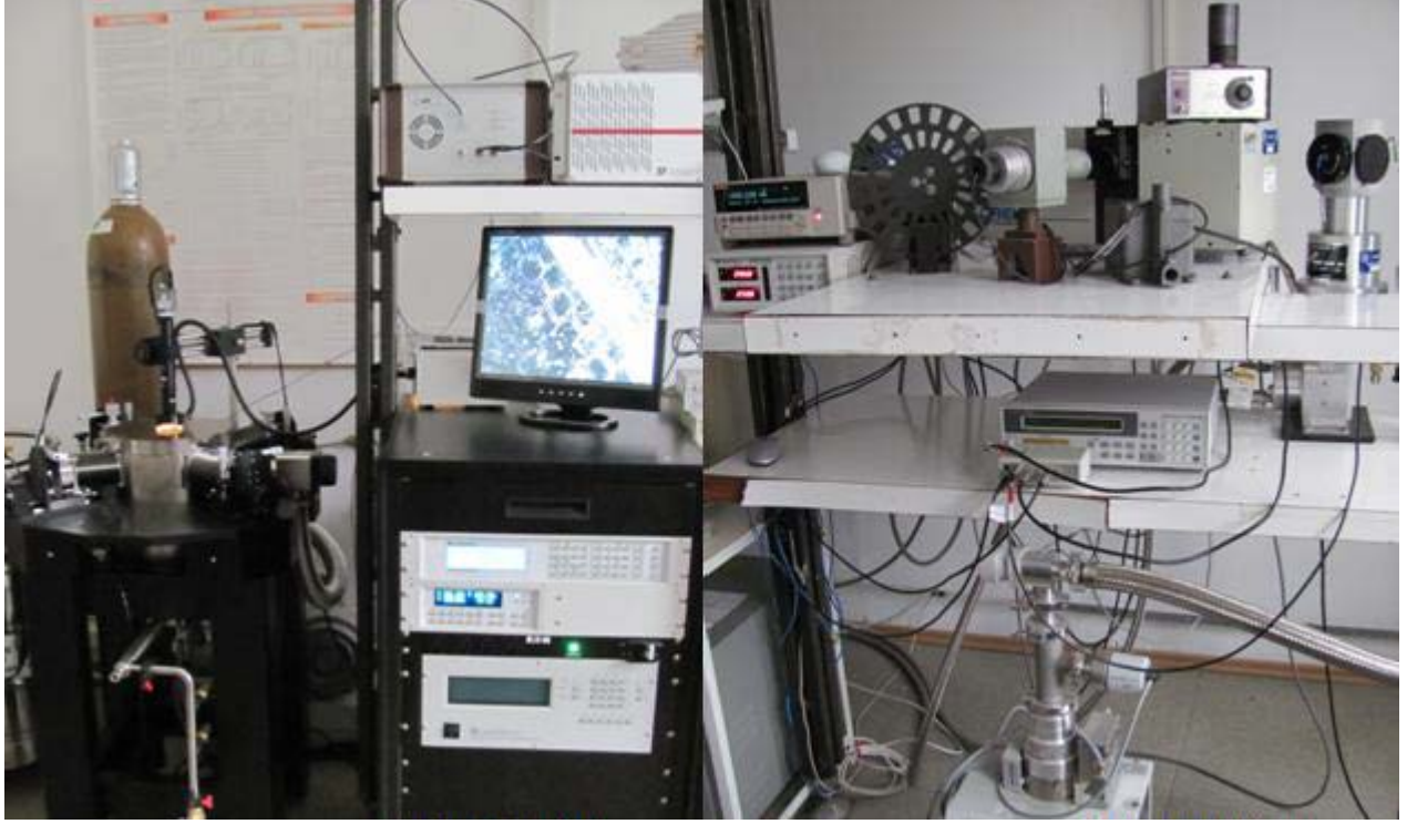
Şekil 15. I-V ölçümlerinin yapıldığı düzeneğe. En sol: Soğutucu odacık, Orta: Keithley Ampermetre, Sağ alt köşe: Soğutucuya bağlı pompa düzeneği. Ekrandan kapalı devre optik mikroskop ile soğutucu odacık içinde kontaklanan elektrotlar görüntülenebilmektedir.
