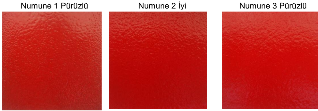
Şekil 4.7 Taşıyıcı toz besleme basıncına göre üretilen numunelerin makro görüntüleri
