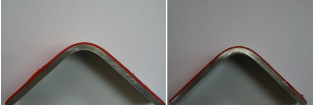
Şekil 4.43 3 nokta eğme testi uygulanan kaplama numunelerinin makro görüntüsü
