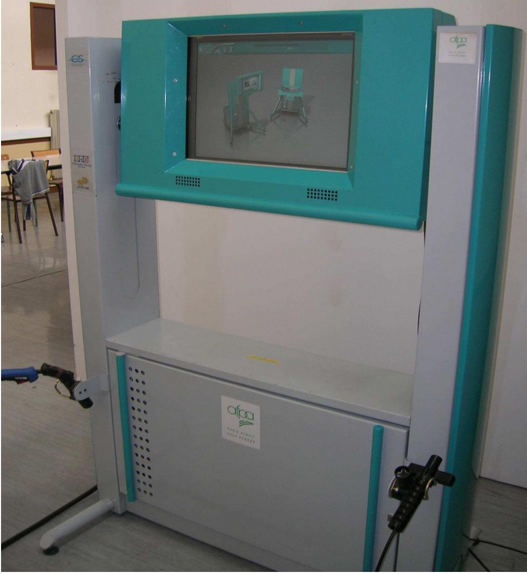
Şekil 8.4. Afpa CS WAVE sanal simülatörü Beta-1 versiyonu
