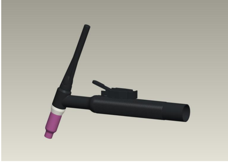
Şekil 4.8. TIG kaynak torcunun Pro/ENGINEER modeli (montaj resmi)
