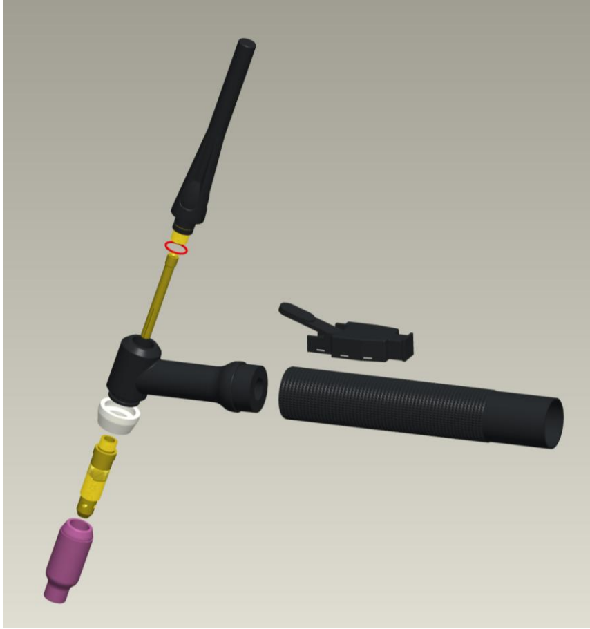
Şekil 4.9. TIG kaynak torcunun Pro/ENGINEER modeli (patlatılmış montaj resmi)
