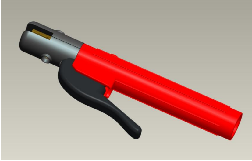
Şekil 4.11. Elektrik Ark kaynak torcunun Pro/ENGINEER modeli (montaj resmi, elektrotsuz)
