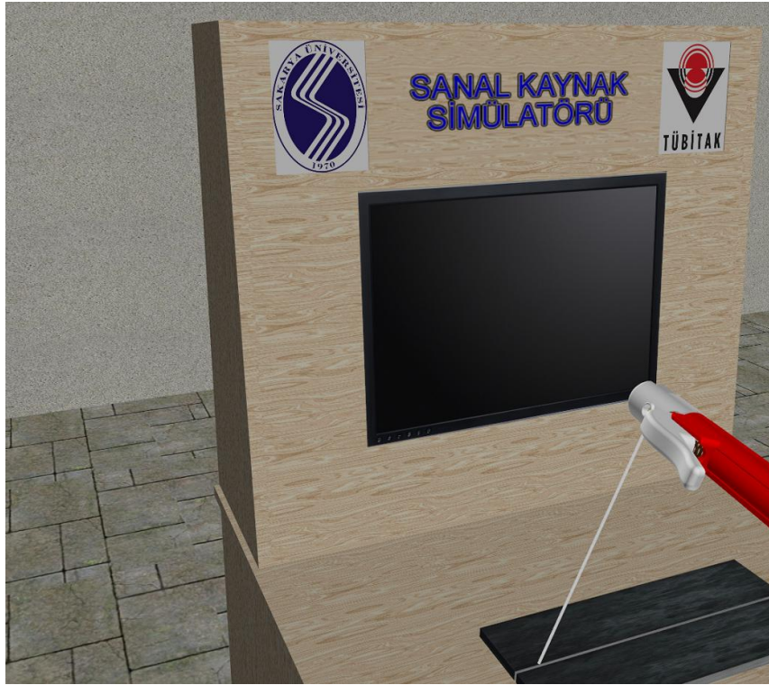
Şekil 4.17. Elektrik Arc Kaynak Torcunun Grafik Motoru İle Gerçek Zamanlı Çizimi
