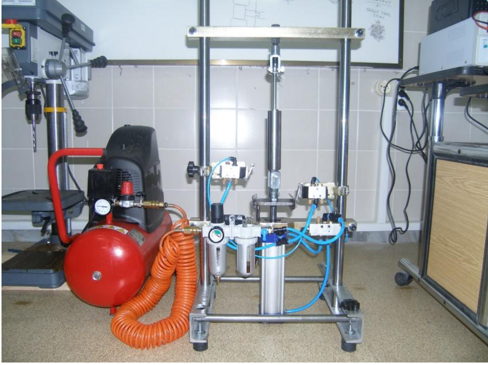
Şekil 4.2. MR Damper alıştırma ünitesi
