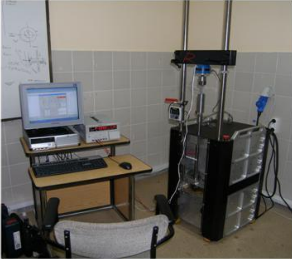
Şekil 4.3. Roehrig Damper test ünitesi
