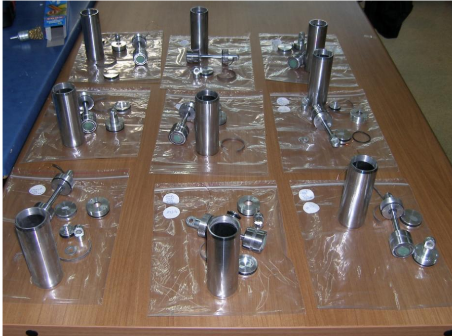
Şekil 4.1. İmal edilen MR damperlerin montaj öncesi görüntüsü
